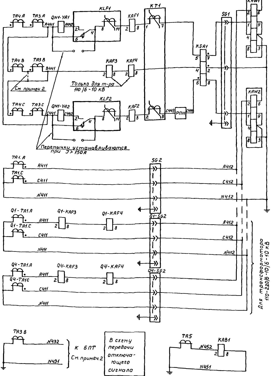
Дифференциальная токовая защита, МТЗ, защита от перегрузки, КУ, обдувка, реле контроля тока в линии, Реле контроля тока в короткозамыкателе
