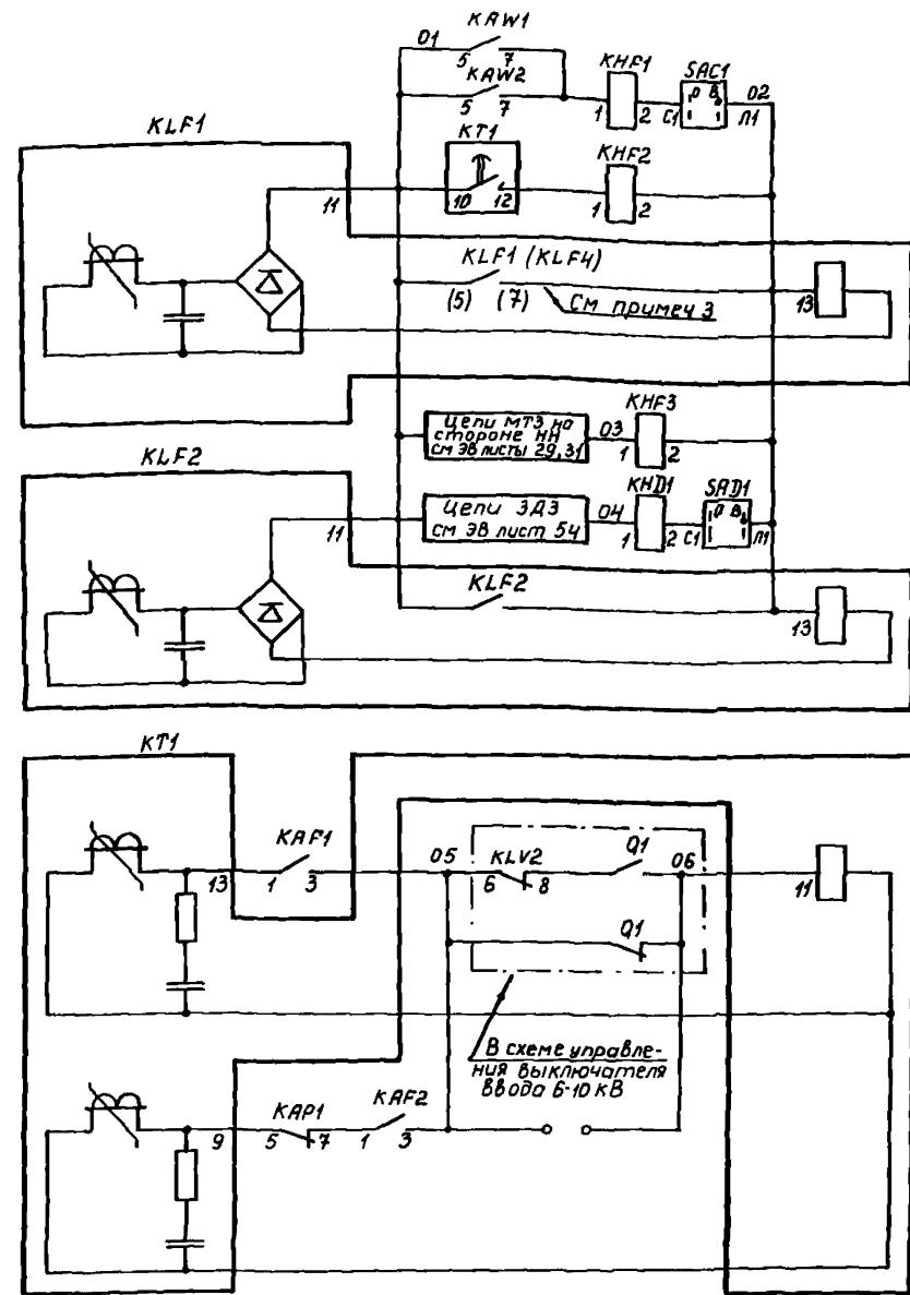
Выходные цепи промежуточных реле дифференциальной токовой защиты, МТЗ и ЗДЗ
