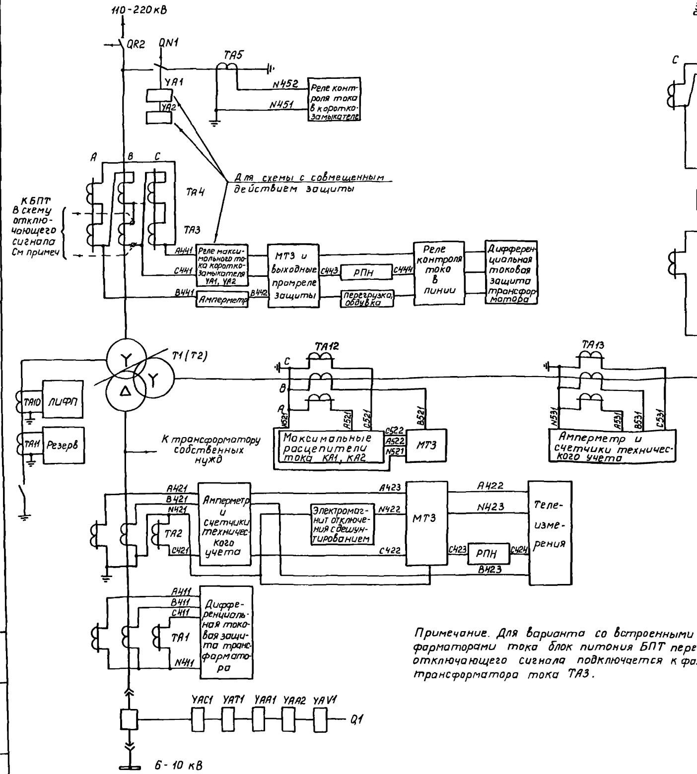
Примечание. Для варианта со встроенным трансформатором тока блок питания БПТ передачи отключающего сигнала подключается к фазе В трансформатора тока ТА3.
