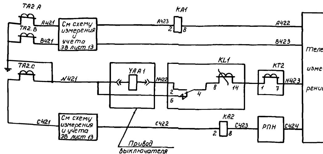
Дешунтирование токовой катушки отключающим выходным реле защиты. Реле МТЗ, РПН, приборы учёта и измерения
