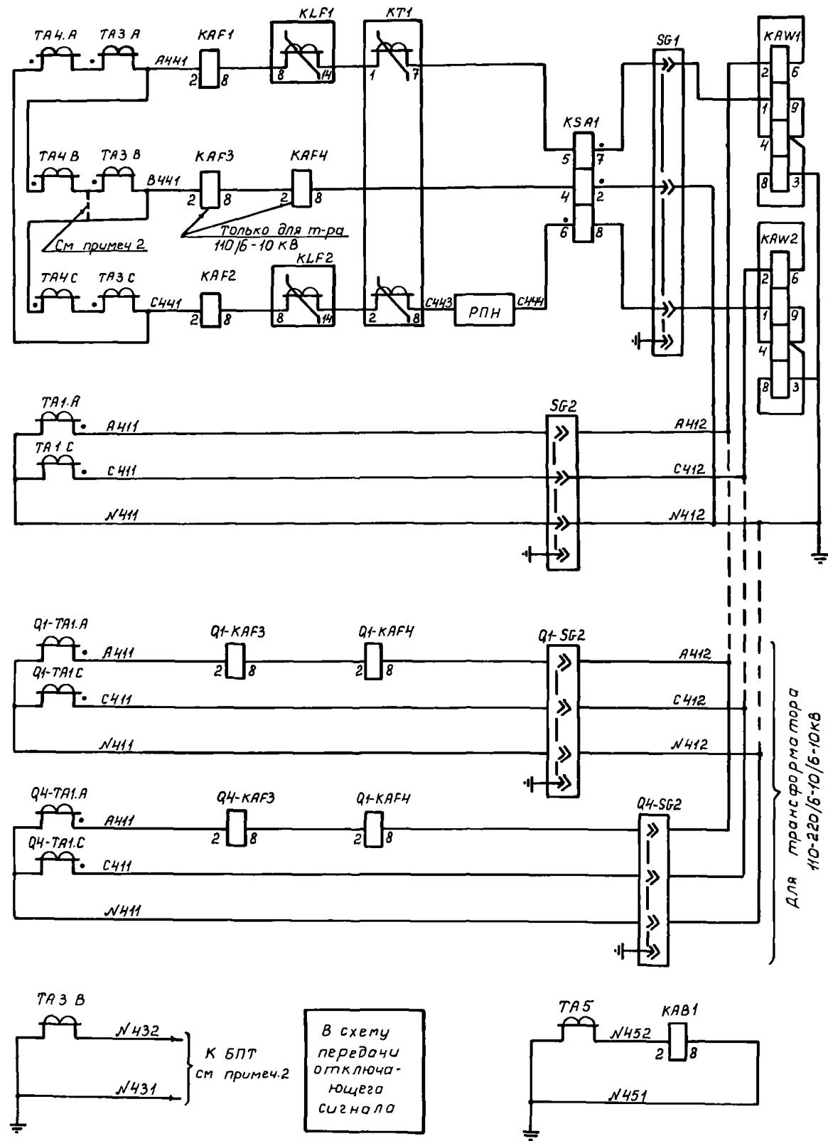
Дифференциальная токовая защита, МТЗ, защита от перегрузки, обдувка, реле контроля тока в линии, Реле контроля тока в короткозамыкателе
