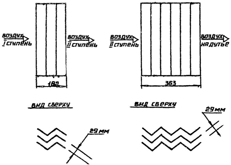
РИС. 3.2. ПРИНЦИПИАЛЬНАЯ СХЕМА КОНСТРУКЦИИ СЕПАРАТОРОВ
