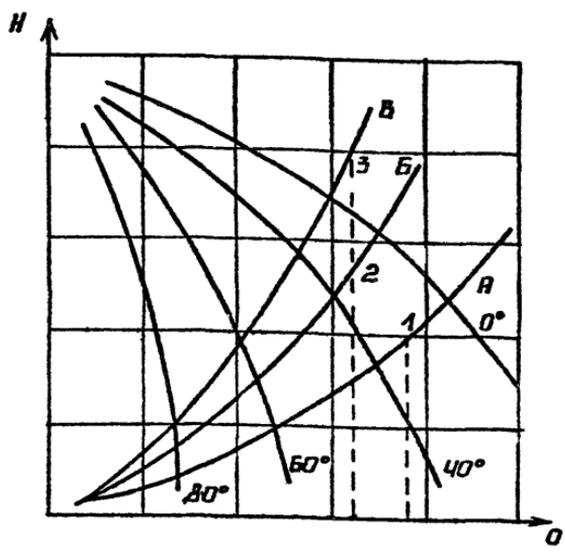
**РИС.4.5. АЭРОДИНАМИЧЕСКИЕ ХАРАКТЕРИСТИКИ ВЕНТЛЯТОРА**
