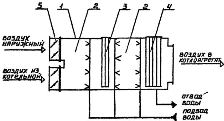
РИС. 2.1. ПРИНЦИПИАЛЬНАЯ СХЕМА КТМО- ПОДОГРЕВАТЕЛЯ ДУТЬЕВОГО ВОЗДУХА
