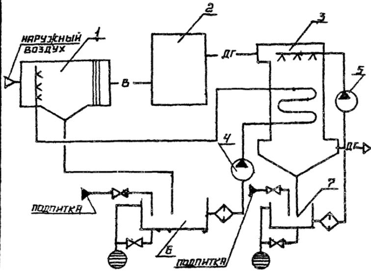
Рис. 4. 2. ТЕПЛОВАЯ СХЕМА ВКЛЮЧЕНИЯ АППАРАТА КТМО-НДВ
