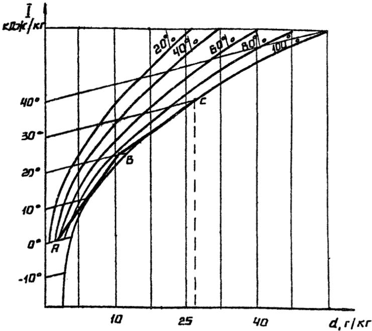
Рис. 2.2. ПРОЦЕСС НАГРЕВА ВОЗДУХА В КТМО
