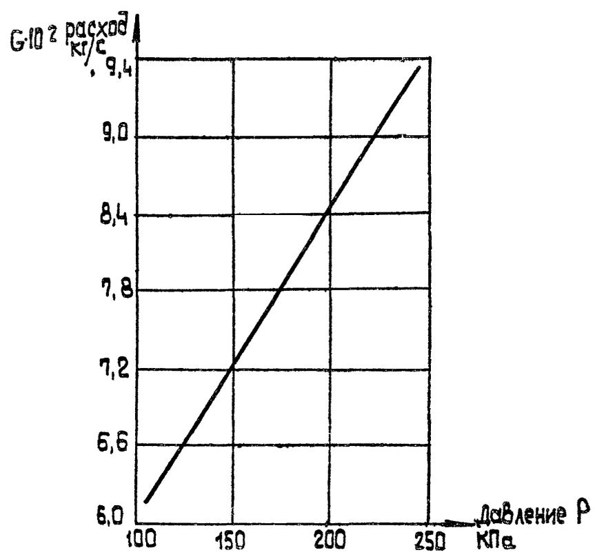
Рис 3.1. Расходная характеристика форсунки шф 7/3,5
