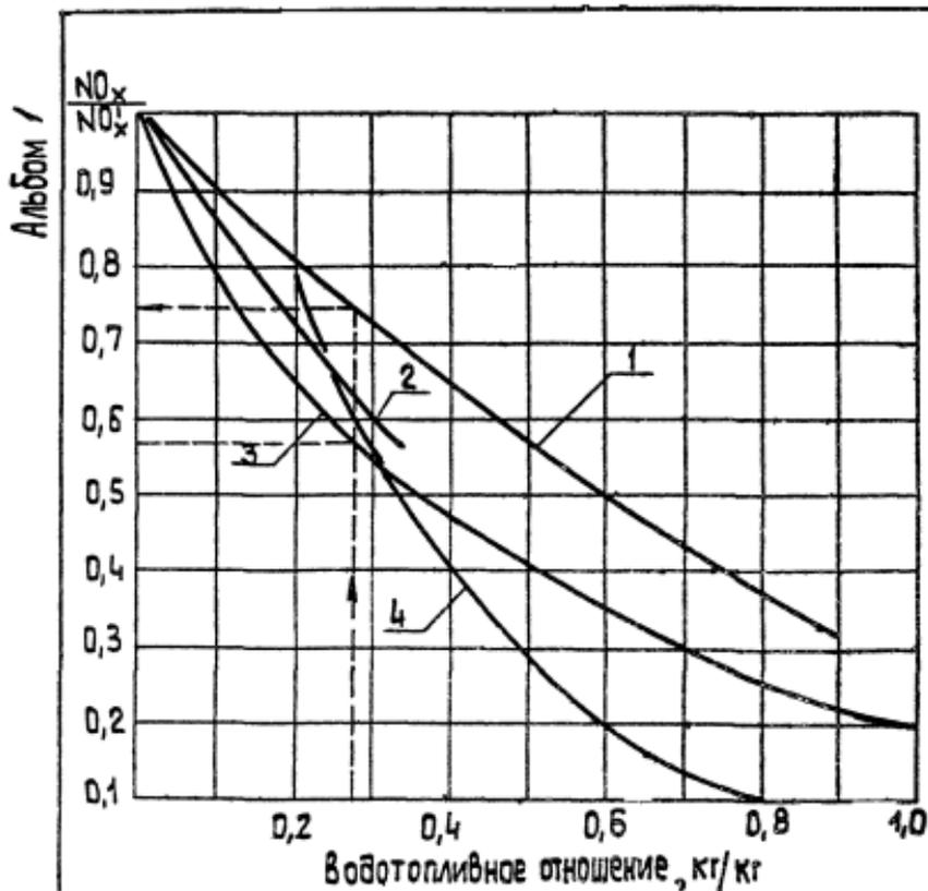
Рис. 5.1. диаграмма снижения выбросов окислов азота
