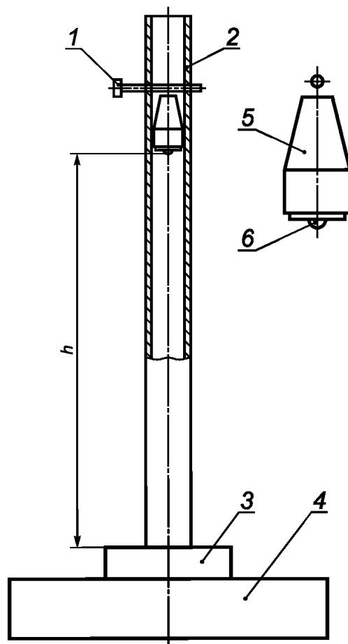
1 — регулировочный штифт; 2 — пластмассовая направляющая труба; 3 — испытуемый образец; 4 — стальная основа (масса  $\geq 20$  кг); 5 — стальной груз массой 1 кг; 6 — ударная головка диаметром 25 мм из закаленной стали;  $h$  — высота падения
