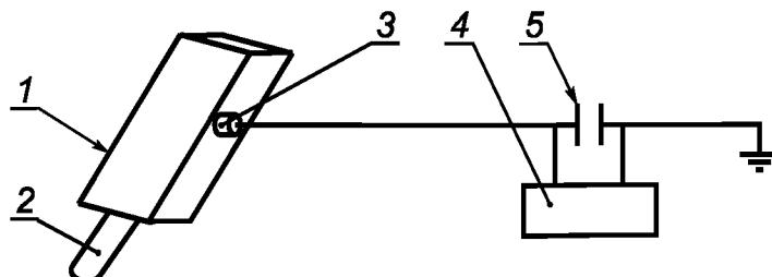
1 — испытуемый образец с накопленным зарядом; 2 — тефлоновая ручка; 3 — сферический электрод; 4 — вольтметр диапазоном измерения от 1 до 10 В; 5 — конденсатор емкостью 0,1 мкФ
