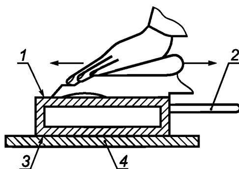
1 — поверхность A; 2 — тефлоновая ручка (или щипцы для перемещения испытуемого образца); 3 — поверхность B; 4 — изолятор из политетрафторэтилена
