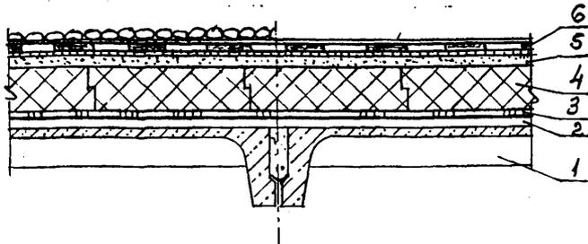
КР9. Рис. 2. ТО ЖЕ ПРИ УСИЛЕНИИ ТЕПЛОИЗОЛЯЦИИ
