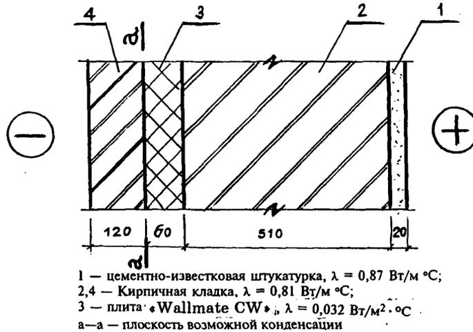
4. Требуемое сопротивление паропрооницанию слоев стены до плоскости возможной конденсации по СНиП II-3-79\* должно быть не менее его значения
