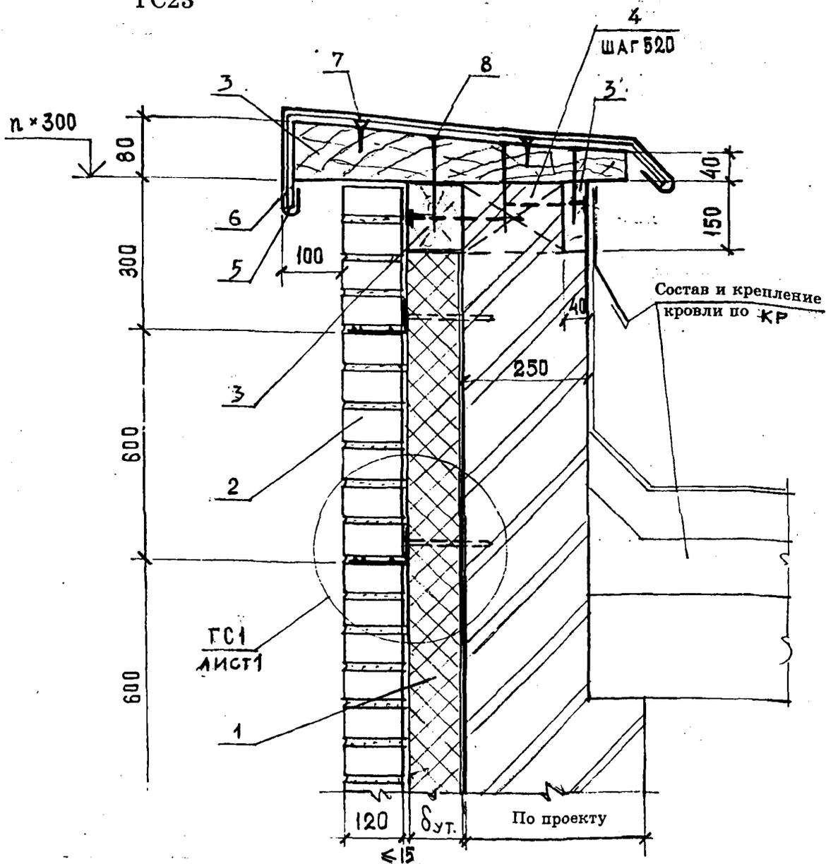
1. Плиты теплоизоляции марки «Wallmate CW»; ( марки «Styrofoam JB» )
