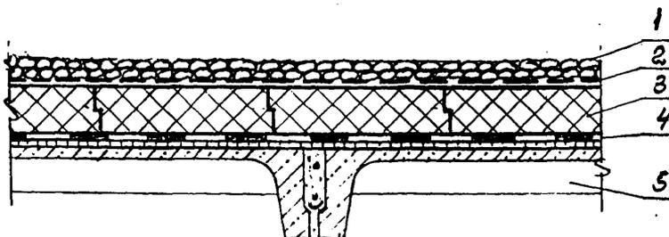
КР1. Рис. 5 ТО ЖЕ, ПРИ УСИЛЕНИИ ТЕПЛОИЗОЛЯЦИИ
