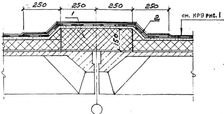
1 - пенобетон  $\gamma=500 \text{ кг/м}^3$
