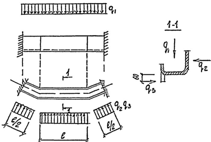
РАСЧЕТНЫЕ НАГРУЗКИ НА ЛОТКИ
