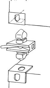
Рис. 11. Поворотный штыковой замок
