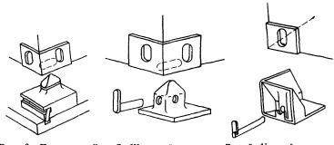
Рис. 6. Поворотный штыковой замок
