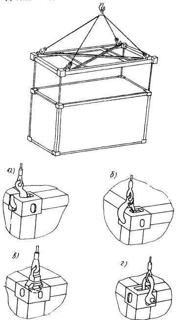
Рис. 1. Подъем контейнера за верхние угловые фитинги контейнерной подвеской, выполненной в виде рамы:
