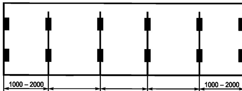
Рисунок В.7 — Контейнеры типов 1ЕЕ, 1АА, 1А или 1АХ (без тоннеля для установки на полуприцепе с передней балкой типа «шея гуся»).
