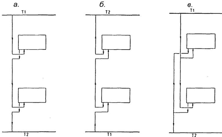
Рис. 2.3. Схемы подсоединения конвекторов «Экотерм» к стоякам системы отопления: а – однотрубная с верхней разводкой подающей магистрали; б – однотрубная с нижней разводкой подающей магистрали; в – двухтрубная с верхней разводкой подающей магистрали
