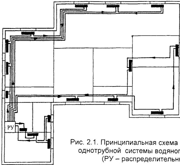
Рис. 2.1. Принципиальная схема поквартирной однотрубной системы водяного отопления (РУ – распределительный узел)
