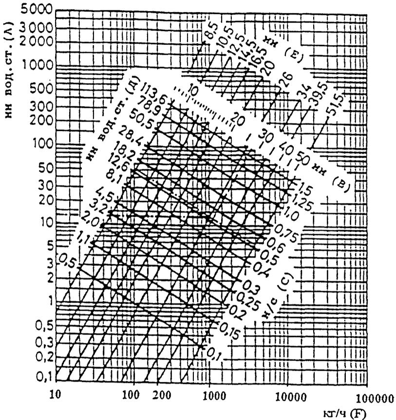
**А** – потери давления на трение в медных трубах 1 м при температуре теплоносителя 40°C, мм вод. ст.;
