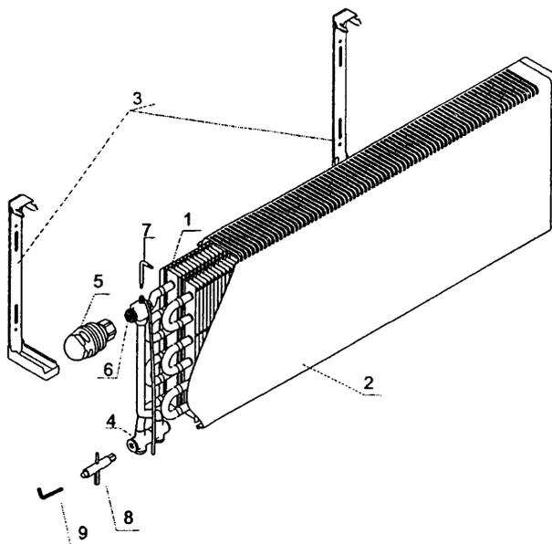
Рис. 1.4. Схема размещения основных узлов конвектора «Экотерм»
