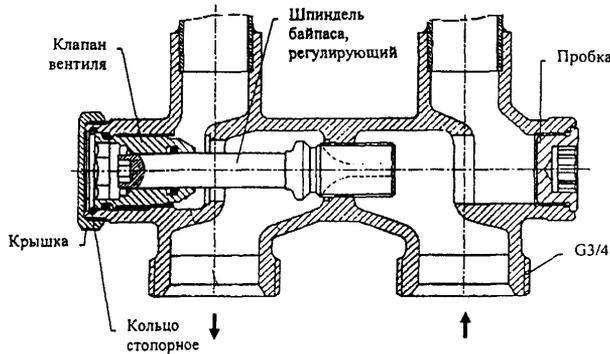
Рис. 1.5. Узел подключения конвектора «Экотерм»
