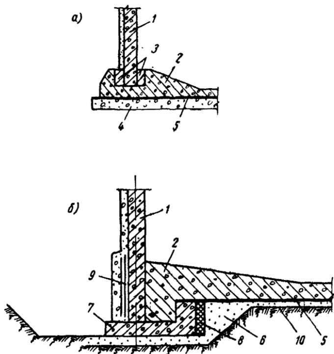
Рис. 1. Узлы сопряжения стены с днищем
