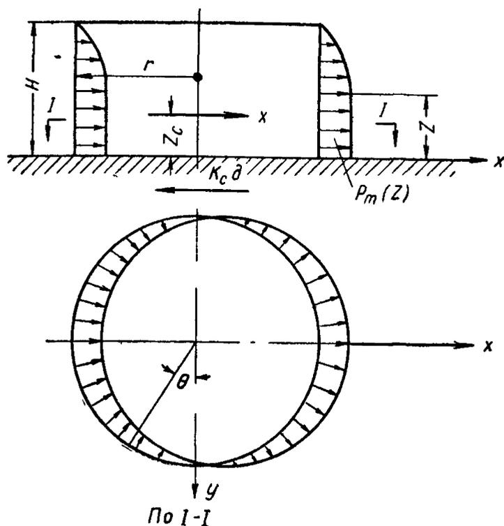
Рис 11 Эпюра сейсмического давления жидкости на стенку резервуара
