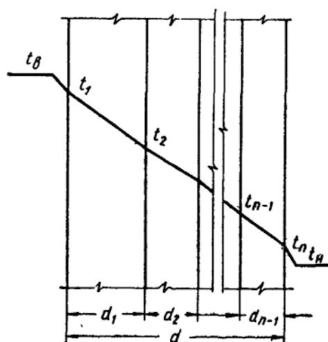
Рис. 7. Распределение температур по толщине многослойного элемента резервуара
