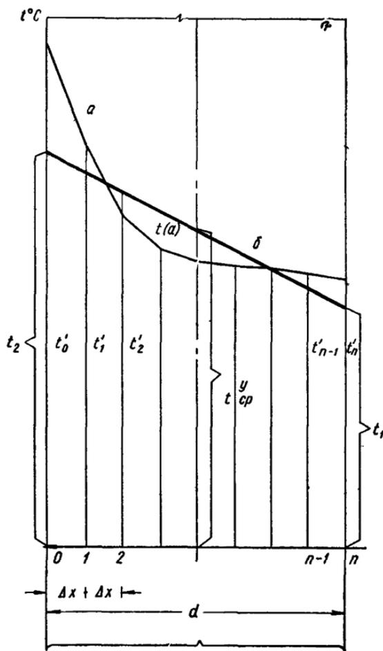
Рис. 6. Эпюры распределения температуры по толщине железобетонных стен, днищ и покрытий резервуаров при нестационарном режиме
