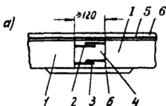
Рис. 2. Конструкции стыков стеновых панелей
