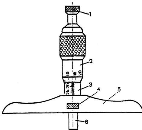
Рис. 11. Микрометрический глубиномер:
