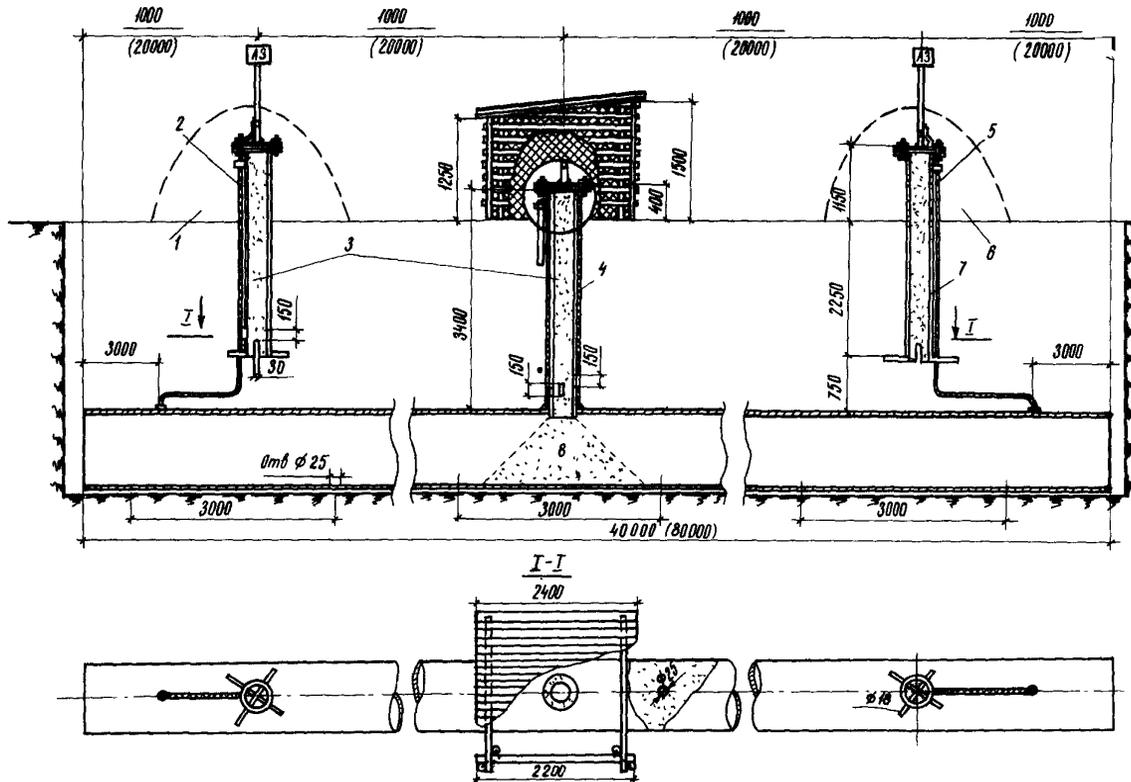
Рис.4. Анодное заземление из отходов стальных труб диаметром 800-1400 мм:
