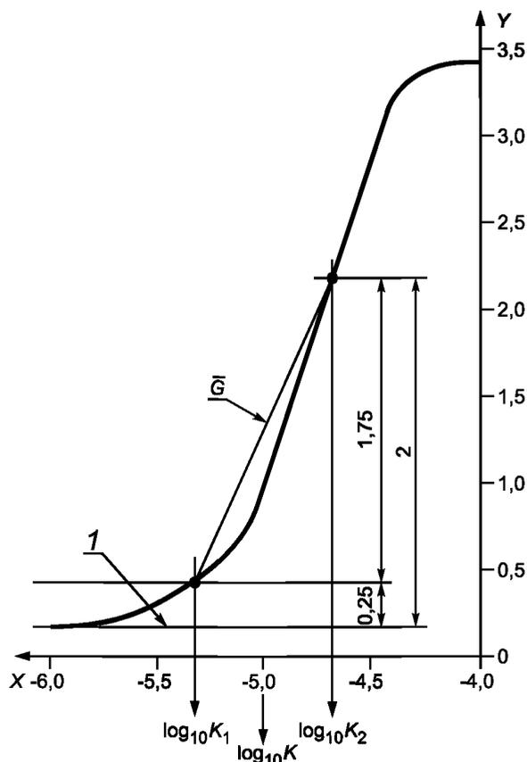
$X$  —  $\log_{10}K$ ;  $Y$  — оптическая диффузная плотность в соответствии с ИСО; 1 — плотность образца обработанной неэкспонированной пленки;  $G$  — средний градиент
