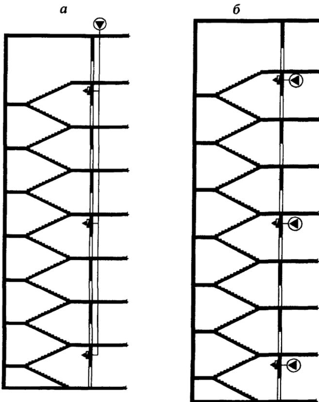
*Рис. 4. Схема распределенной подачи воздуха в лестничную клетку:*
