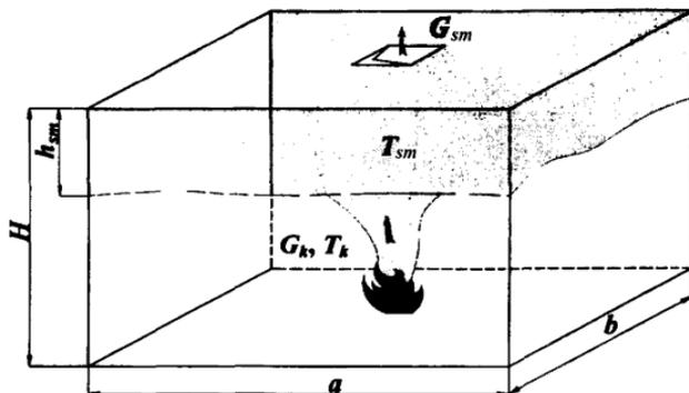
Рис. 1. Расчетная схема газообмена в горящем помещении, защищаемом вытяжной противодымной вентиляцией ( $T_k$  – температура конвективной колонки,  $h_{sm}$  – предельно допустимая толщина дымового слоя)
