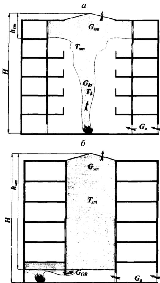
Рис. 2. Расчетная схема газообмена при пожаре в атриуме с конструктивно неотделенными галереями (а) и с конструктивно отделенными этажами (б)
