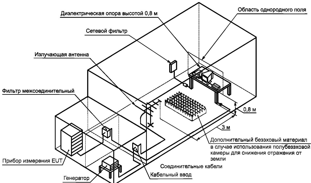
Рисунок 7 — Пример испытательной установки для испытания на устойчивость к излучаемым радиопомехам
