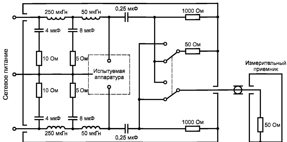
а) Пример V-образной схемы сети питания  $50 \text{ Ом}/\mu\text{Гн} + 5 \text{ Ом}$  при использовании диапазона частот от 10 до 150 кГц
