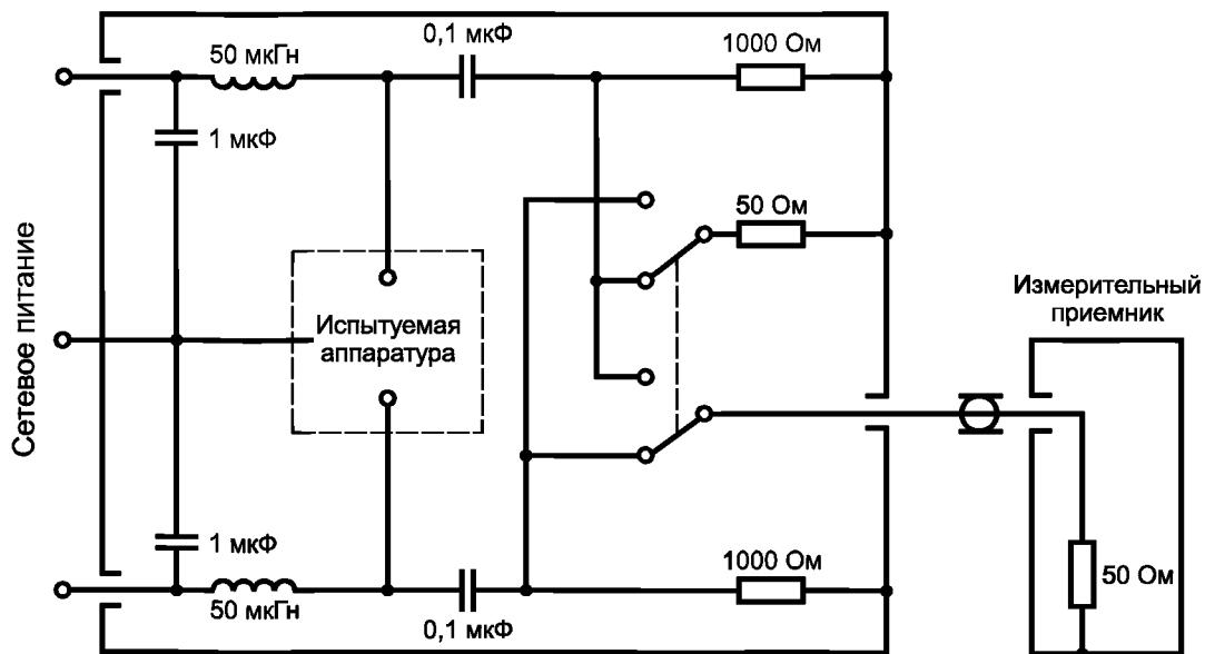
б) Пример V-образной схемы сети питания  $50 \text{ Ом}/\mu\text{Гн}$  при использовании диапазона частот от 150 кГц до 30 МГц
