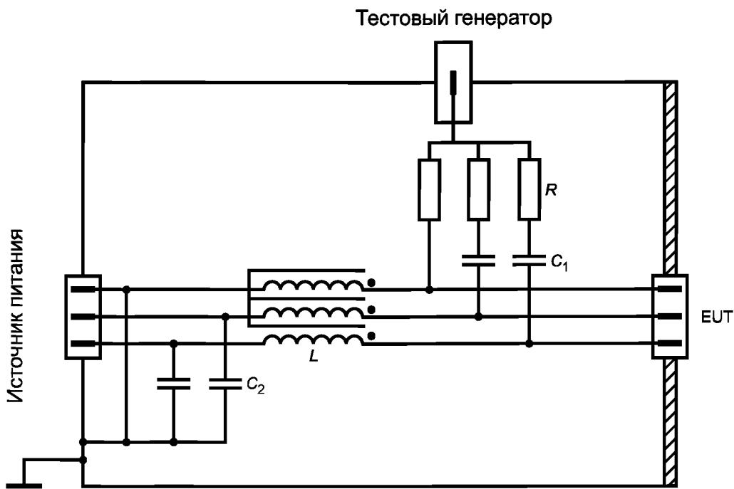
Примечание — CDN = M3,  $C_1$  (typ) = 10 нФ,  $C_2$  (typ) = 47 нФ,  $R$  = 300 Ом,  $L \geq 280$  мкГн для 150 кГц; CDN = M2,  $C_1$  (typ) = 10 нФ,  $C_2$  (typ) = 47 нФ,  $R$  = 200 Ом,  $L \geq 280$  мкГн для 150 кГц; CDN = M1,  $C_1$  (typ) = 22 нФ,  $C_2$  (typ) = 47 нФ,  $R$  = 100 Ом,  $L \geq 280$  мкГн для 150 кГц.
