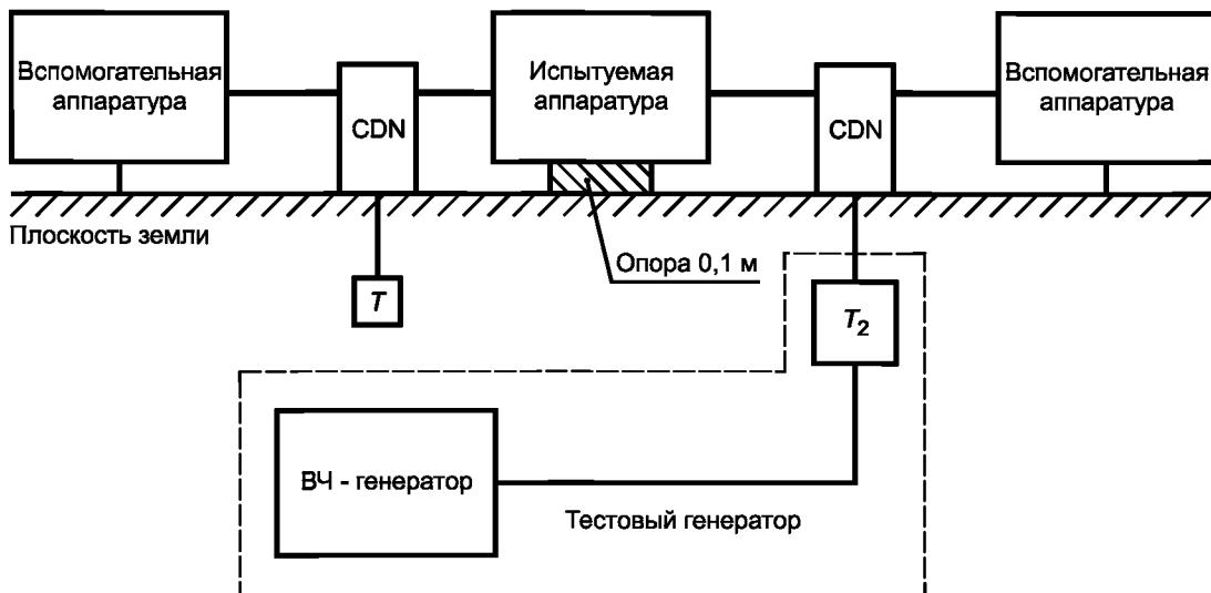
$T$  — нагрузка 50 Ом;  $T_2$  — аттенюатор мощности (6 дБ); CDN — цепь «связи — развязки»
