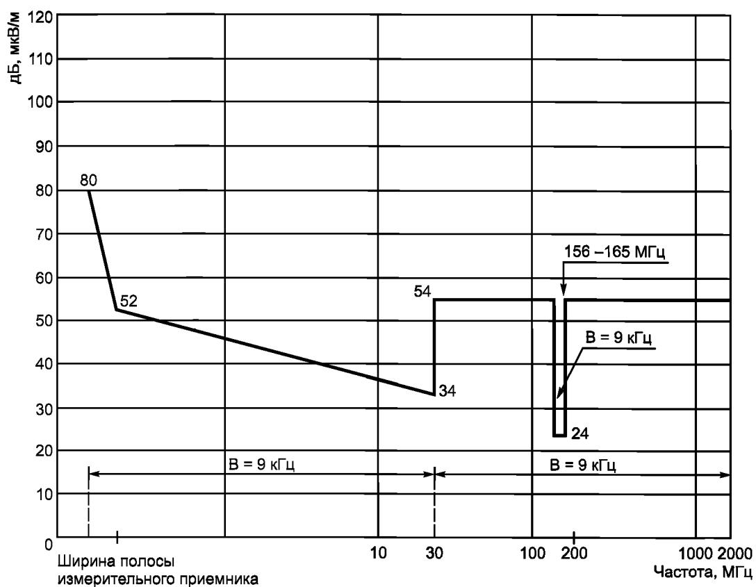
Рисунок 4 — Пределевые уровни излучаемых помех от портов корпуса оборудования
