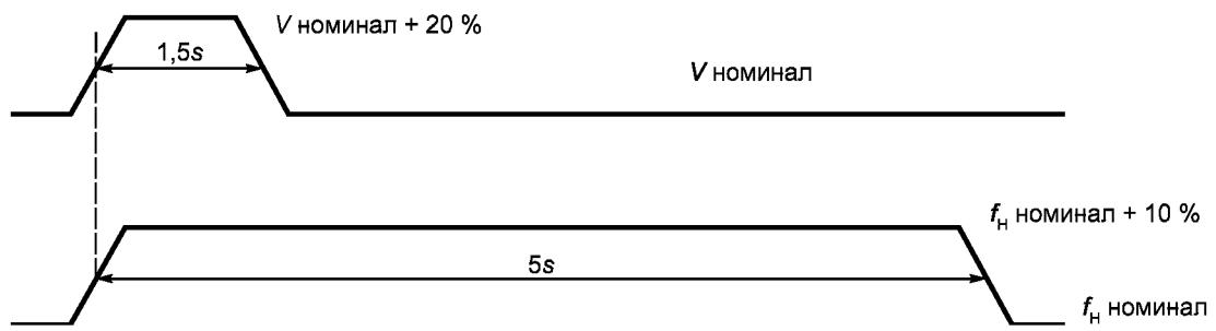
а) Тест 1: напряжение  $V + 20\%$  и частота  $f + 10\%$
