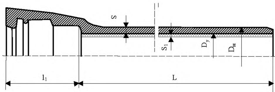
Рисунок А.3 – Труба раструбная под соединение «Тайтон»
