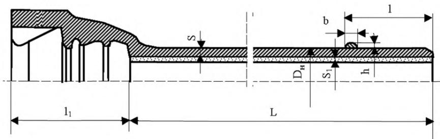
Рисунок А.2 – Труба раструбная под соединение «ВРС»
