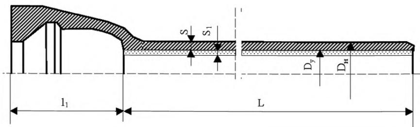
Рисунок А.1 – Труба раструбная под соединение «Универсал»
