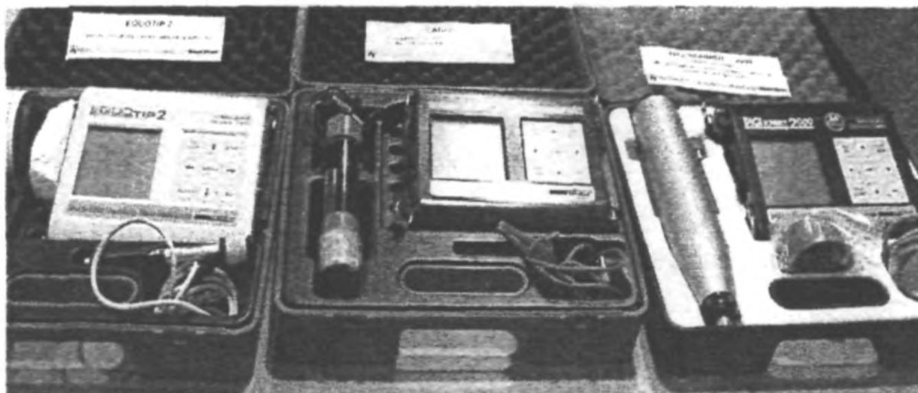
Рисунок А.6. Приборы неразрушающего контроля железобетонных конструкций:
