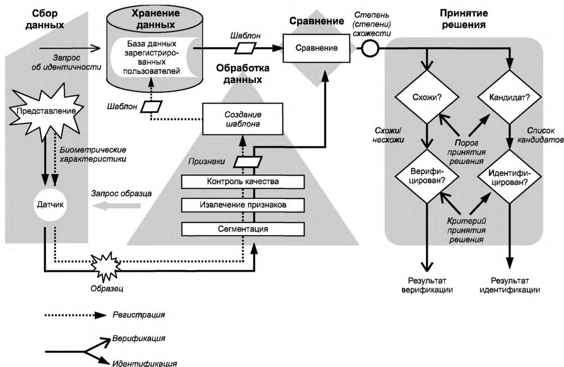
Рисунок 1 — Компоненты обобщенной биометрической системы
