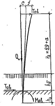
Для разных типов промежуточных опор были определены величины опрокидывающих моментов от расчетных нагрузок аварийного режима работы ВЛ. Результаты расчета приведены в табл. I.
