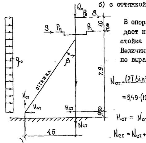
В опорах с оттяжками оттяжка передает на свай вырывающее усилие, стойка - сжимающее.
