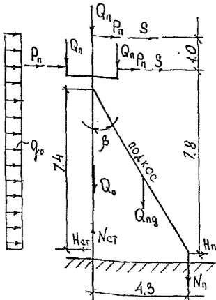
Максимальные нагрузки на фундаменты угловых промежуточных опор имеют место в нормальном режиме работы ВЛ и создаются составляющими от тяжения проводов и ветровыми нагрузками на провода и тело опоры. При этом подкос передает на свай сжимающую нагрузку, стойка - вырывающую.
