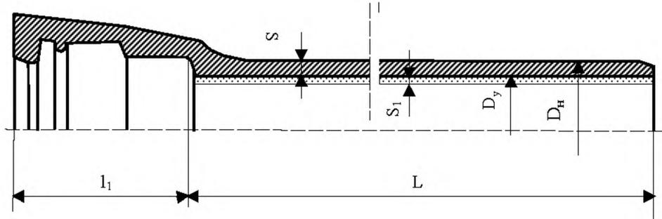
Рисунок А.2 – Труба раструбная под соединение «Тайгон»
