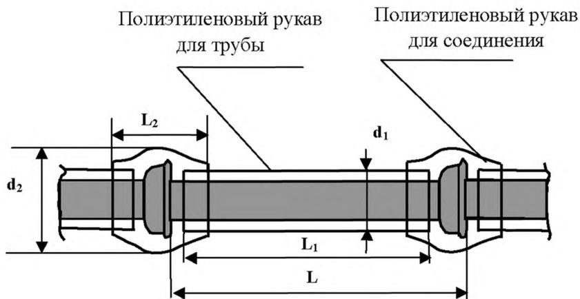
Рисунок А.16 – Полиэтиленовый рукав
