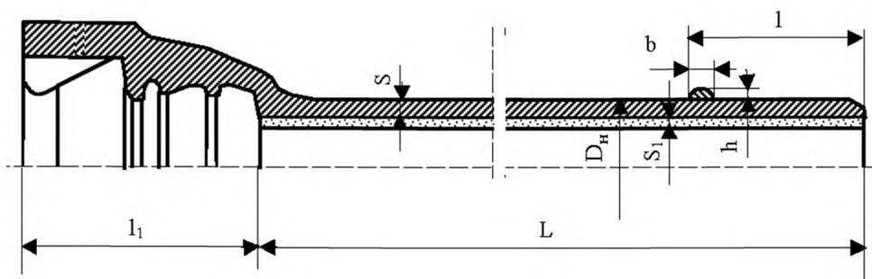
Рисунок А.3 – Труба раструбная под соединение «ВРС»
