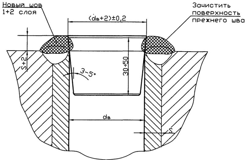
Рисунок 8 - Размеры и варка заглушек в теплообменные трубы
