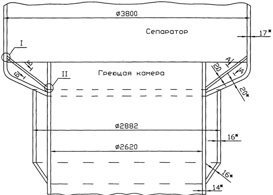
Рисунок 16.3-2 - Установка нового конического днища
