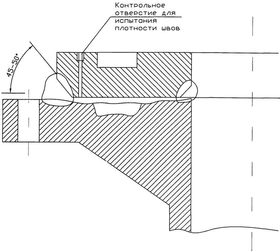
Рисунок 11 - Ремонт уплотнительной поверхности фланцев
