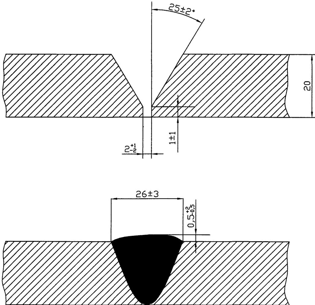
Рисунок 16.3-3 - Сварное соединение сегментных заготовок конического дна (С17 ГОСТ 5264)
