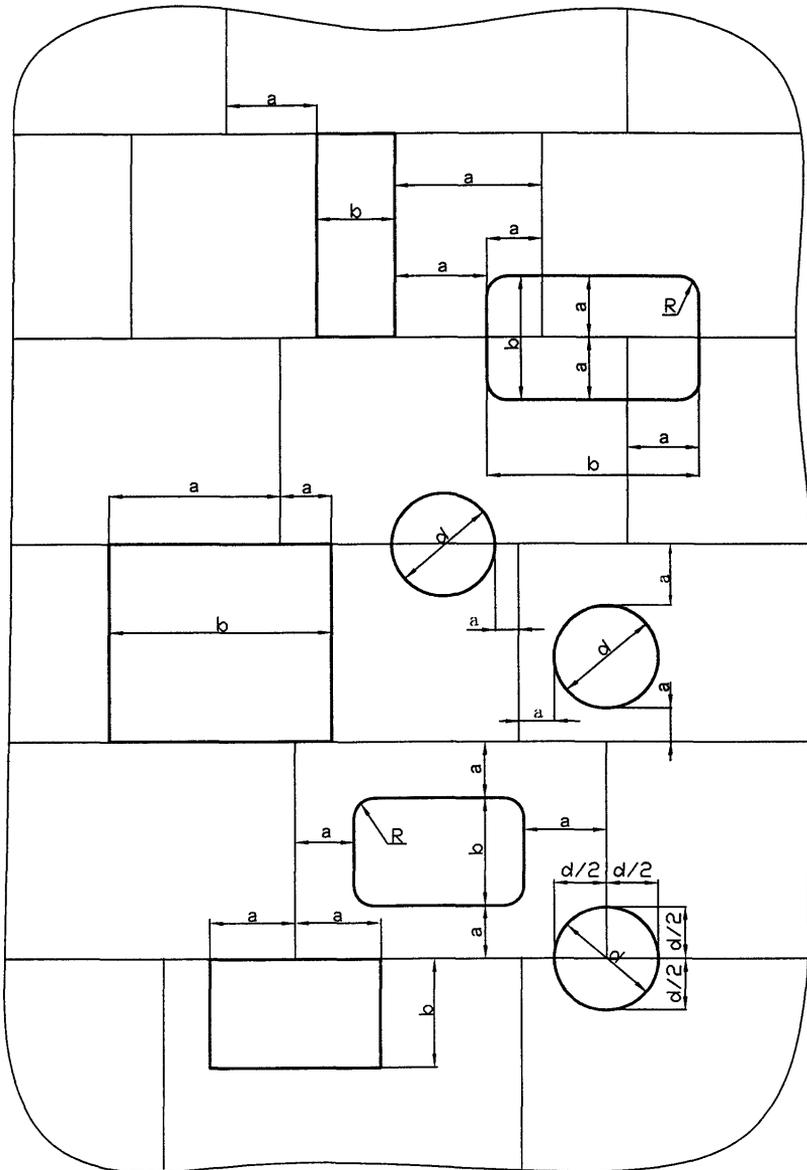
Рисунок 7 - Возможные случаи расположения заплат на корпусе аппарата. Допустимые расстояния между швами:
