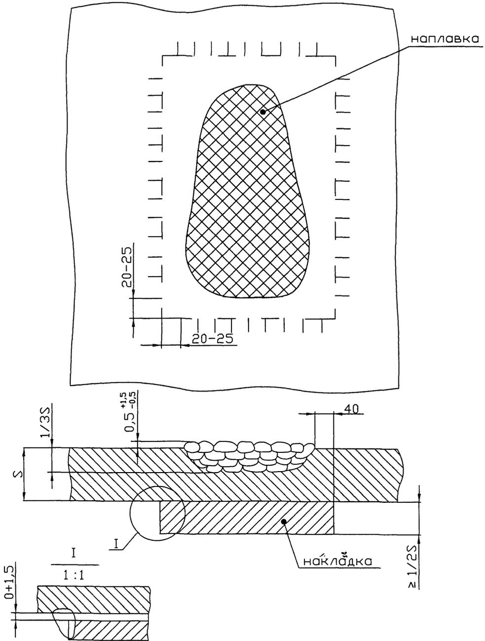
Рисунок 16.9 - Укрепление накладкой стенки корпуса в месте наплавки
