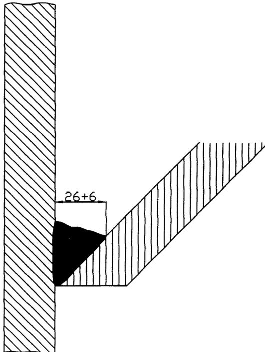
Рисунок 16.3-6 - Конструктивные элементы шва сварного соединения кончского днища со стенкой греющей камеры (Т5ГОСТ 11534)
