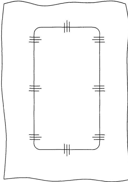
Рисунок 16.7-2 - Схема расположения прихваток
