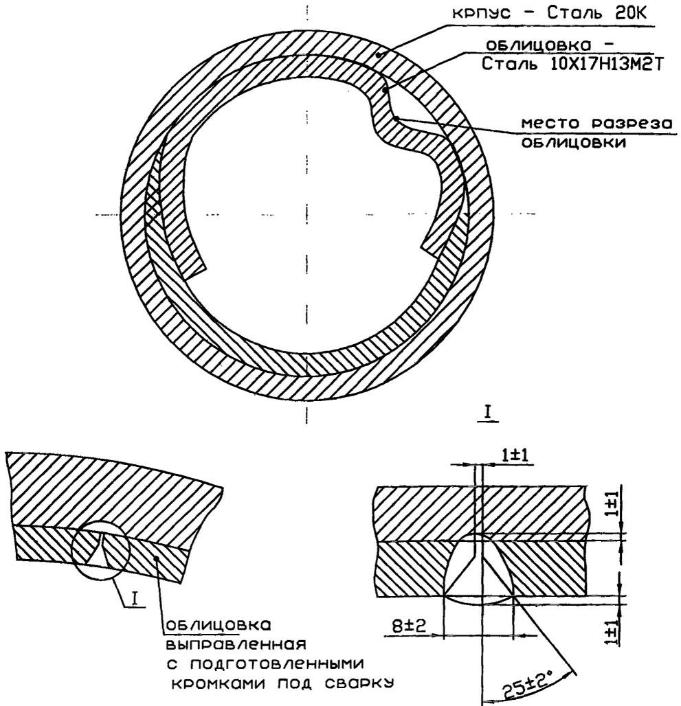
Рисунок 16.7-4 - Подготовка и сварка отслоенной поверхности облицовки
