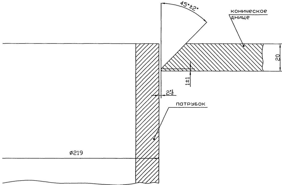
Рисунок 16.3-8 - Конструктивные элементы подготовленных кромок приварки сливного патрубка к коническому днищу (У6 ГОСТ 5264)
