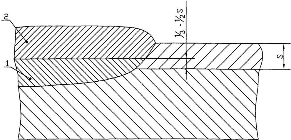
Рисунок 16.6-5 - Заварка электрозаклепок, шпоночных швов
