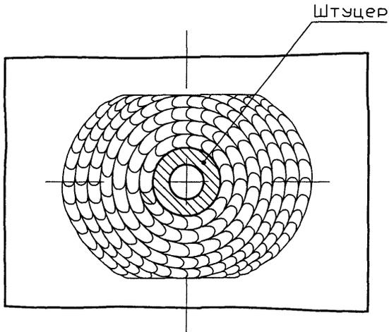
Рисунок 4 - Общая наплавка после выравнивания впадин
