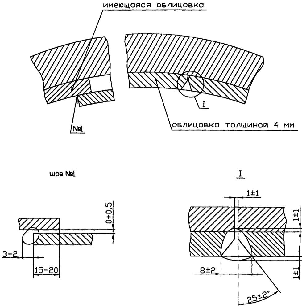
Рисунок 16.7-1 - Облицовка обечайки корпуса
