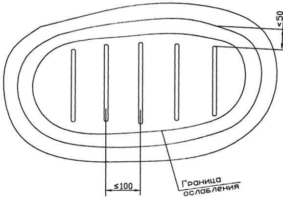
Рисунок 16.6-4 - Параллельные шпоночные швы
