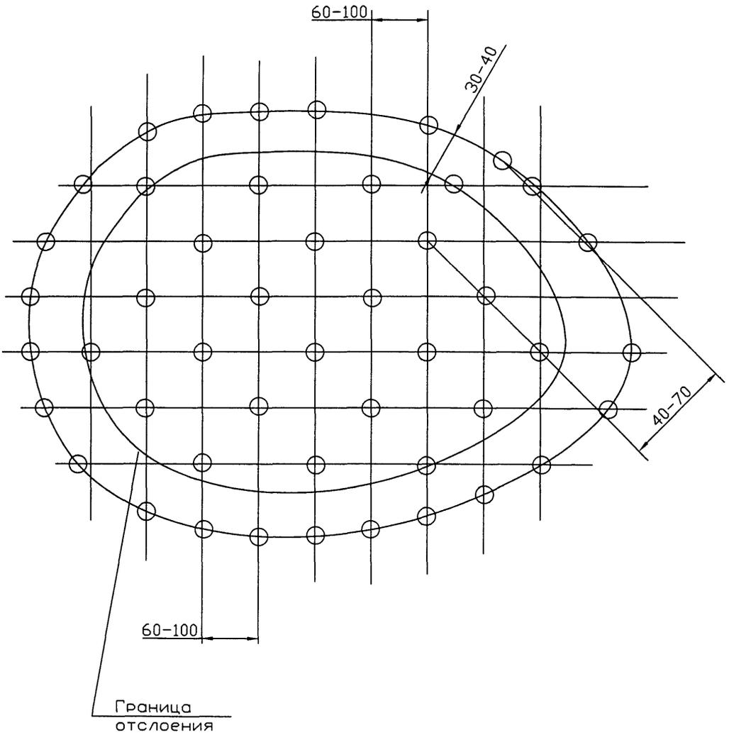
Рисунок 16.6-3 - Ограничение распространения отслоения электрозаклепками
