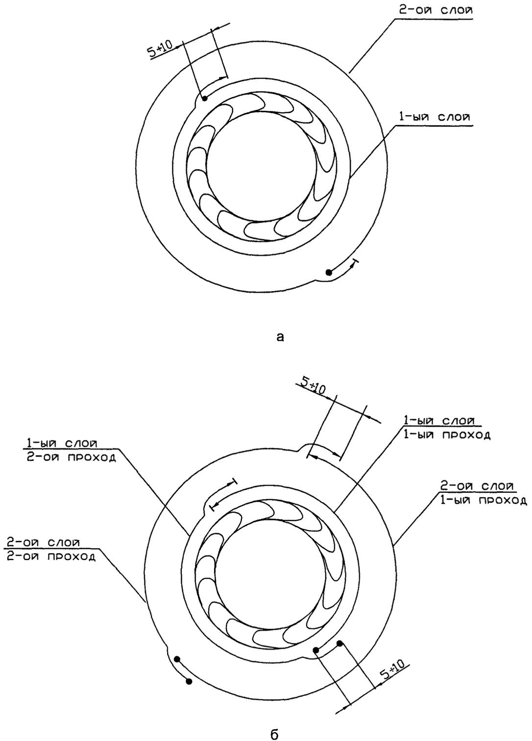
Рисунок 10 - Порядок сварки теплообменных труб с трубными решетками
