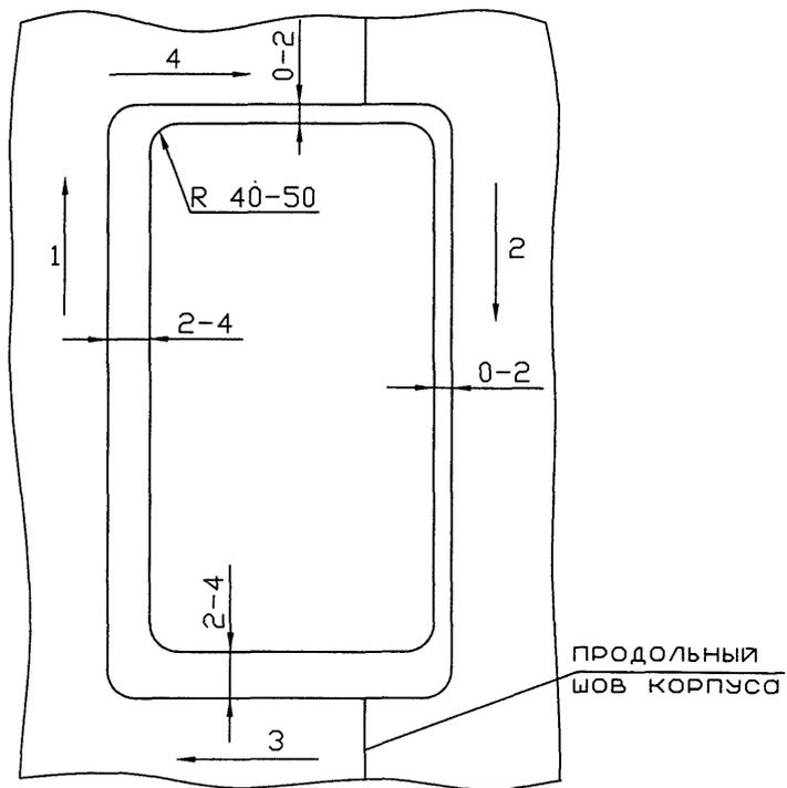
Рисунок 16.1-1 - Схема сборки и сварки вставки с корпусом.
