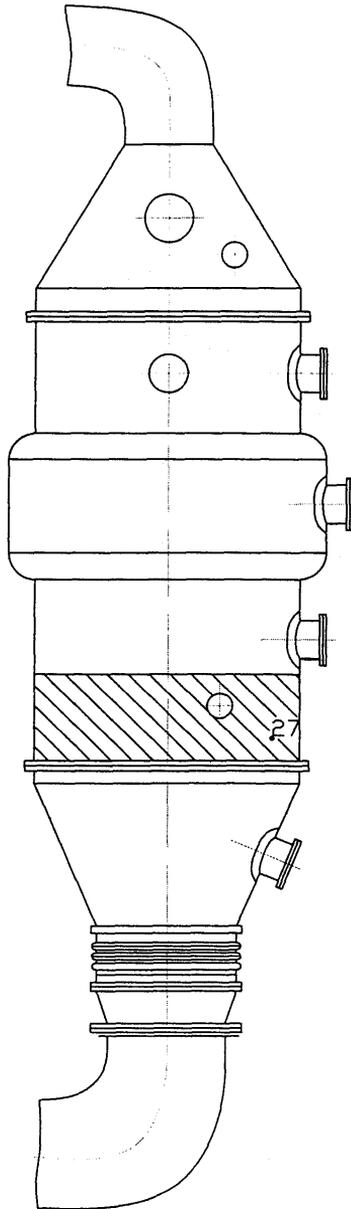
Рисунок 16.4-1 - Греющая камера
