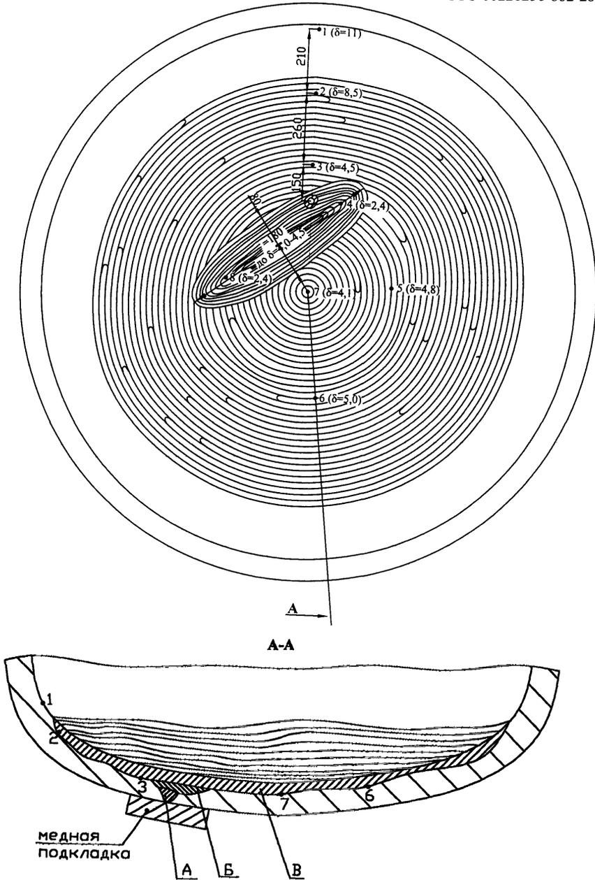
Рисунок 16.2 - Схема выполнения ремонтных работ днища автоклава
