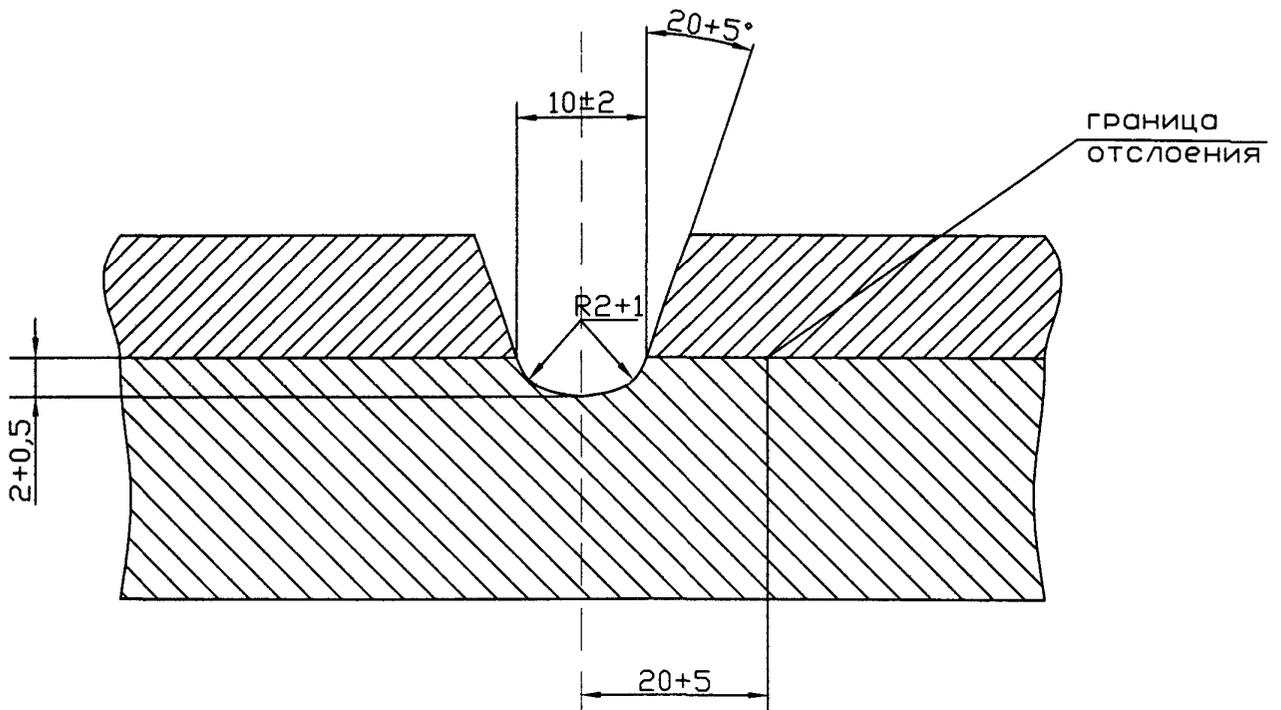
Рисунок 16.6-2 - Разделка пазов под шпоночные швы
