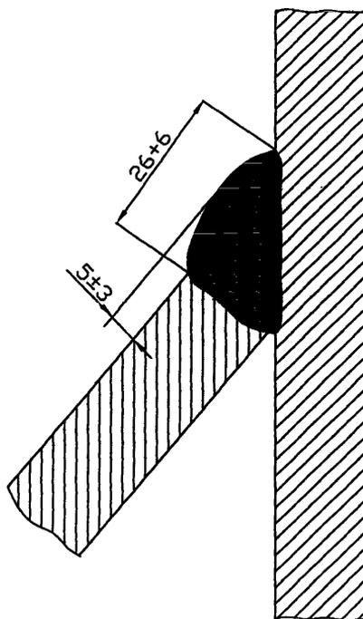
Рисунок 16.3-7 - Конструктивные элементы шва сварного соединения конческого днища со стенкой сепаратора (ТЗГОСТ 11534)
