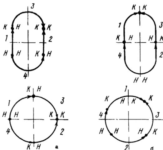
Рис.4. Последовательность выполнения отдельных слоев шва при сварке заплата и патрубков (четырьмя участками протяженностью 100-200 мм каждый):
