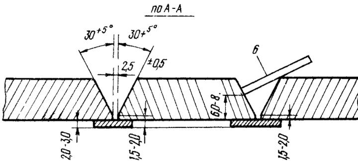
Рис.1. форма и ориентация отверстия, заплата и подкладного кольца и схема разделки кромок под сварку:
