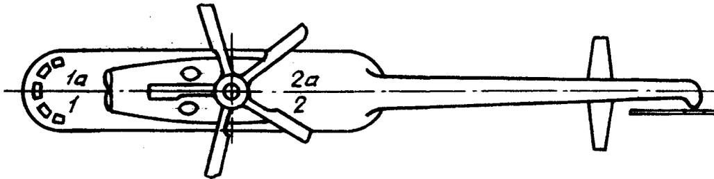
Зоны: 1 - левая носовая часть фюзеляжа; 1а - правая носовая часть фюзеляжа; 2 - левая хвостовая часть фюзеляжа; 2а - правая хвостовая часть фюзеляжа
