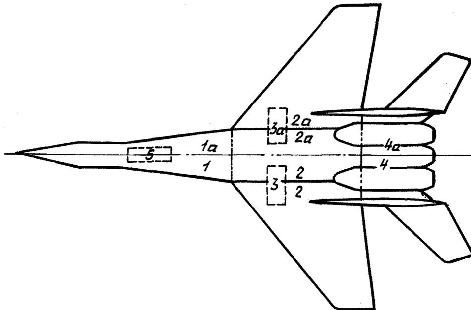
Зоны: 1 - левая носовая часть фюзеляжа; 1а - правая носовая часть фюзеляжа; 2 - левая средняя часть фюзеляжа в пределах передней и задней кромок крыла, корневая часть левой консоли вблизи фюзеляжа; 2а - правая средняя часть фюзеляжа в пределах передней и задней кромок крыла, корневая часть правой консоли вблизи фюзеляжа; 3 - левая ниша шасси; 3а - правая ниша шасси; 4 - левая хвостовая часть фюзеляжа; 4а - правая хвостовая часть фюзеляжа; 5 - передняя ниша шасси
