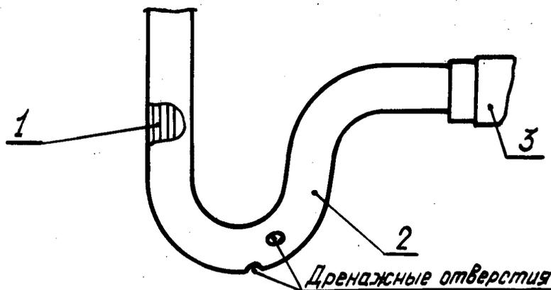
1 - жгут; 2 - защитная трубка; 3 - соединитель
