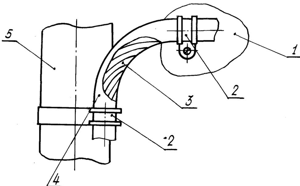
1 - фюзеляж; 2 - хомут; 3 - жгут; 4 - защитная оболочка; 5 - стойка шасси
