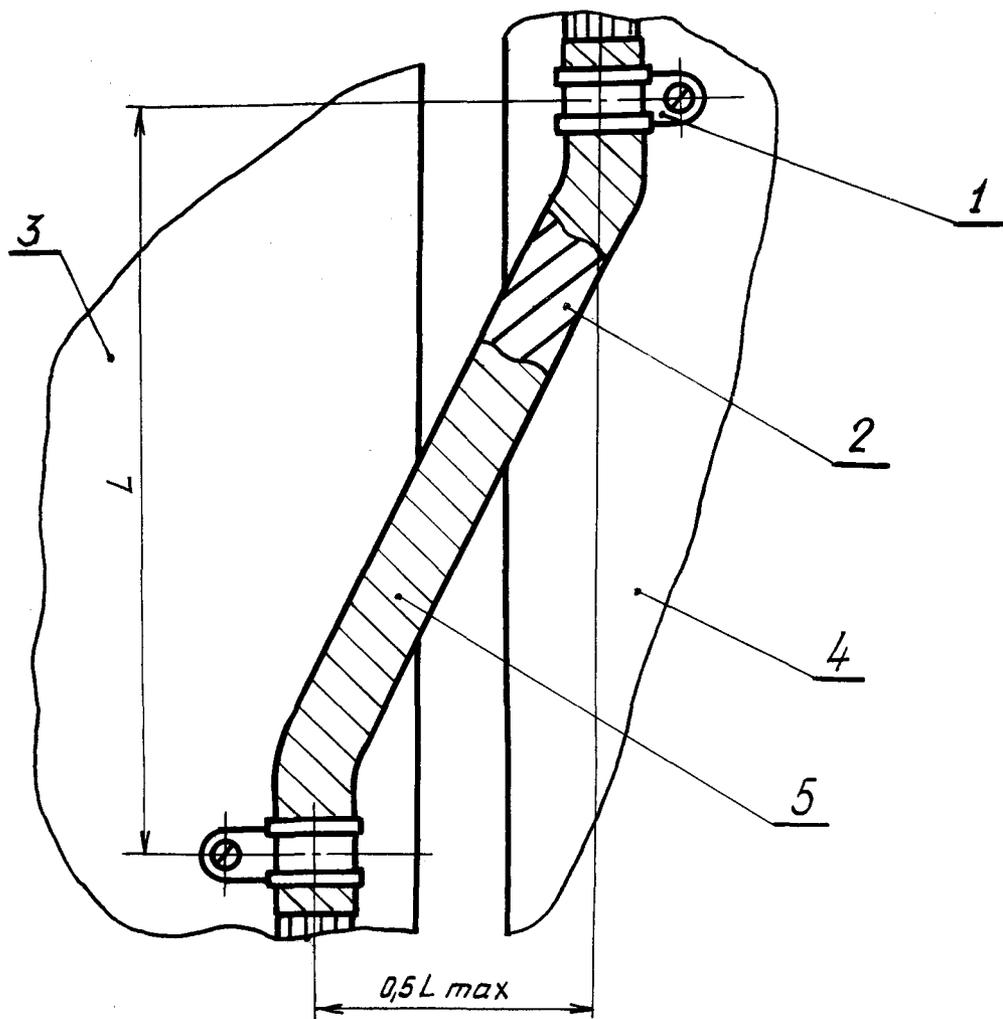
1 - хомут; 2 - жгут; 3 - откидная панель; 4 - корпус; 5 - защитная лента
