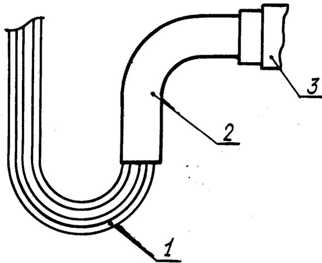
1 - жгут; 2 - защитная трубка; 3 - соединитель
