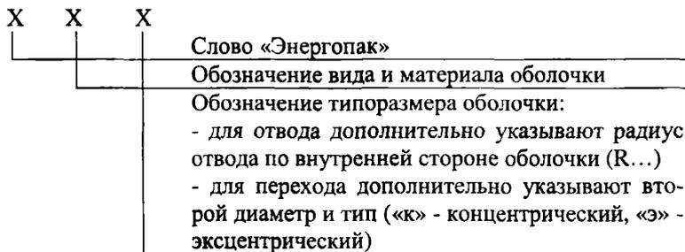
Пример условного обозначения тройника «Энергопак» диаметром 90 мм, изготовленного из стали оцинкованной толщиной 0,5 мм:
