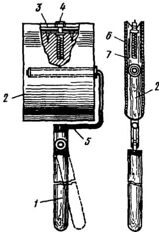
1 – ручка; 2 – корпус; 3 – прижимная планка; 4 – винт; 5 – вилка; 6 – поролон; 7 – наждачная шкурка
