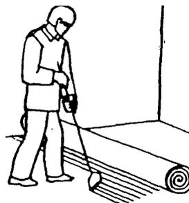
Рисунок 9 – Разравнивание клея гребенкой
