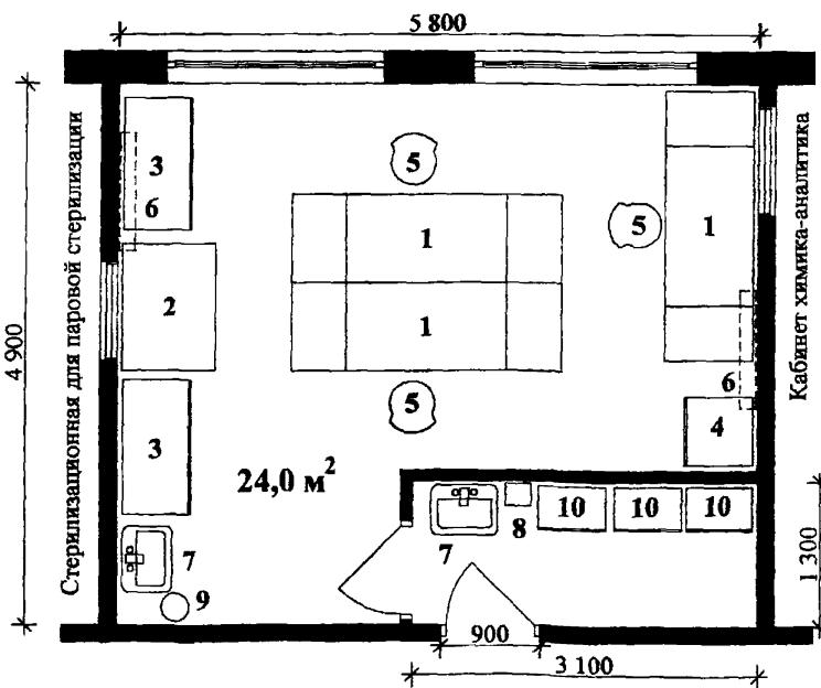
Рис. 2.1 Ассистентская-асептическая со шлюзом для больниц на 1000 коек
