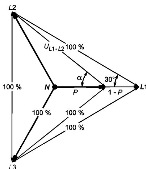
$L1, L2, L3$  — фазные провода;  $N$  — нейтральный провод;  $P$  — напряжение при провале «фаза — нейтраль», выраженное в долях номинального напряжения «фаза — нейтраль» (см. 3.4);  $U_{L1-L2}$  — напряжение от  $L1$  к  $L2$ , выраженное в долях номинального напряжения «фаза — фаза»;  $\alpha$  — угол между напряжением  $U_{L1-L2}$  и напряжением от  $L1$  к  $N$  («фаза — нейтраль») при провале напряжения
