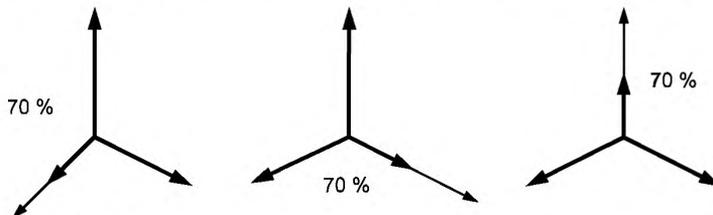
Примечание — Испытания «фаза — нейтраль» проводят в каждой фазе по отдельности
