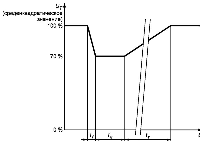
$t_f$  — время понижения напряжения;  $t_r$  — время нарастания напряжения;
