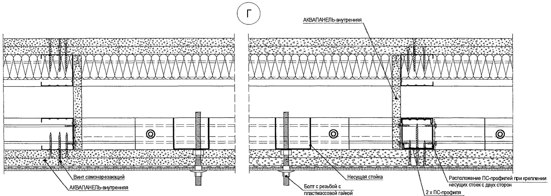
Гидроизоляция узла примыкания
