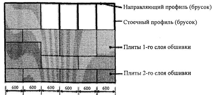
Рис. 2. Крепление плит при двухслойной обшивке
