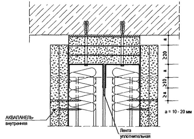
При ожидаемом (расчетном) значении прогиба вышележащего перекрытия более 10 мм следует предусматривать подвижное присоединение перегородки к потолку
