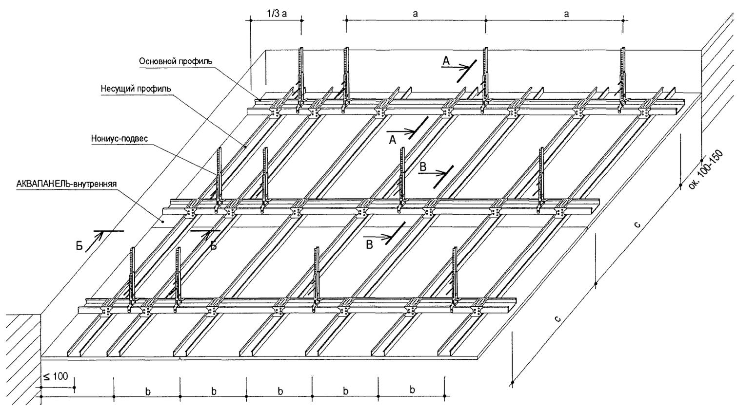
Межосевые расстояния крепления элементов каркаса
