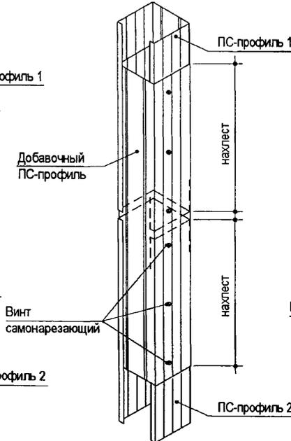
2 ПС-профиля, соединенных встык и объединенных дополнительным ПН-профилем
