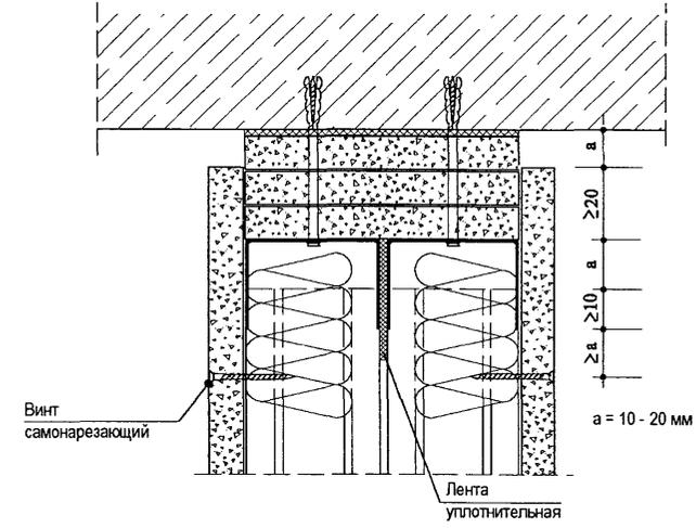
При ожидаемом (расчетном) значении прогиба вышележащего перекрытия более 10 мм следует предусматривать подвижное присоединение перегородки к потолку
