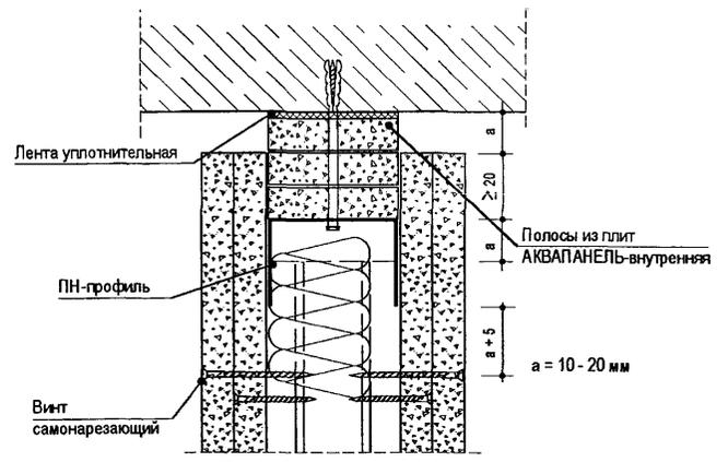
При ожидаемом (расчетном) значении прогиба вышележащего перекрытия более 10 мм следует предусматривать подвижное присоединение перегородки к потолку
