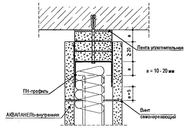
При ожидаемом (расчетном) значении прогиба вышележащего перекрытия более 10 мм следует предусматривать подвижное присоединение перегородки к потолку
