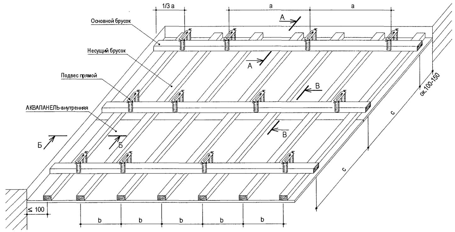
Межосевые расстояния крепления элементов каркаса
