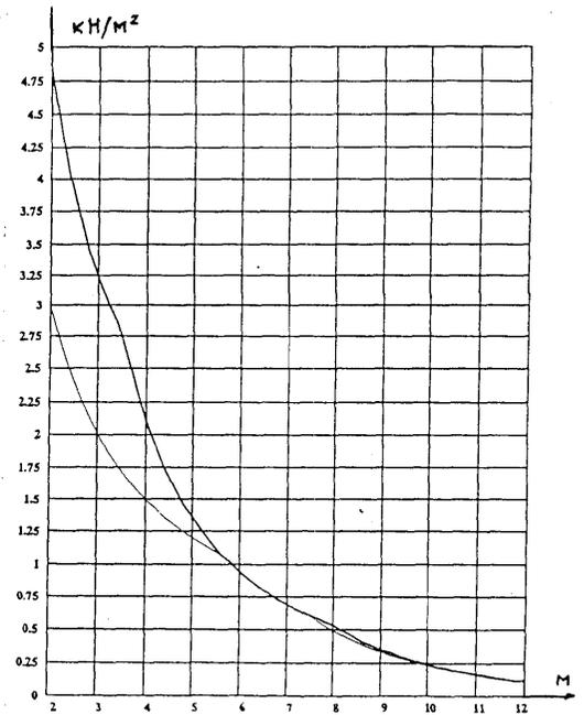
Рис.3 Зависимость “пролет-нагрузка” для однопролетных панелей
