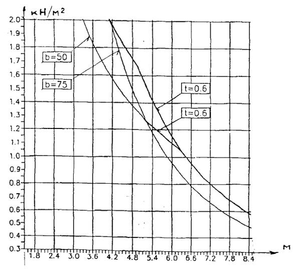
Рис.4. Зависимость "пролет-нагрузка" для однопролетных панелей 50 F 100 (в) и 50 F 150 (г);
