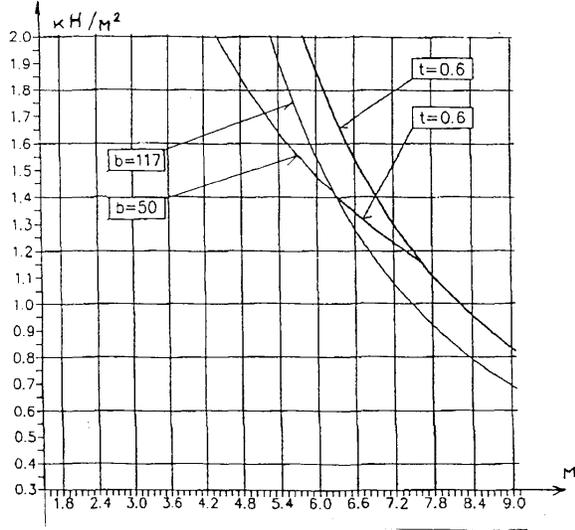
Рис.4. Зависимость “пролет-нагрузка” для однопролетных панелей 50 F 200 (д) и 50 F 240 (е);
