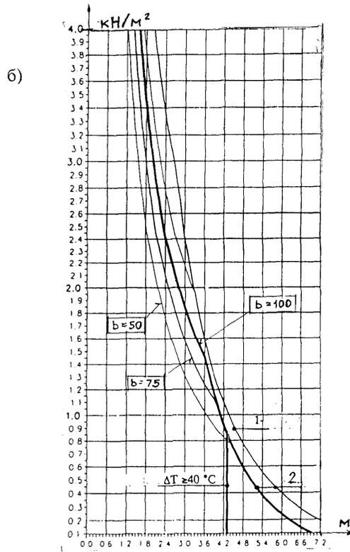
Рис.5 Зависимость “пролет-нагрузка” для двухпролетных панелей
