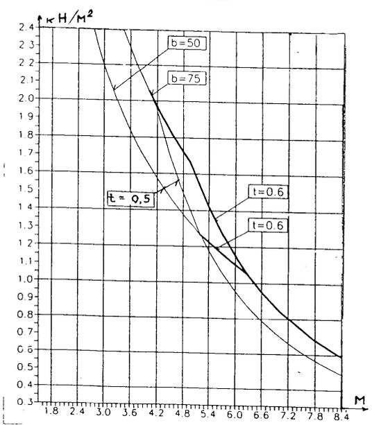
Рис.3. Зависимость “пролет-нагрузка” для однопролетных панелей 50 С 100 (в) и 50 С 150 (г);
