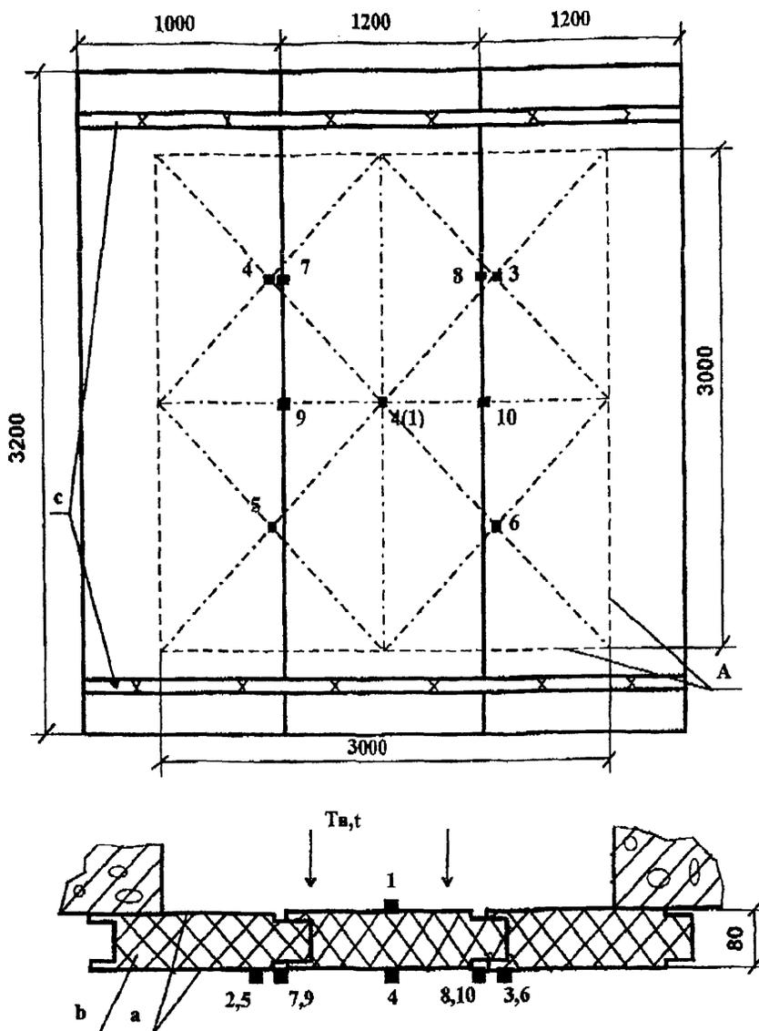
Рис.1. Эскиз конструкции и схема расстановки термомпар при испытании на огнестойкость опытных образцов перегородок из трехслойных панелей толщиной 80 мм производства фирмы "Pafos":
