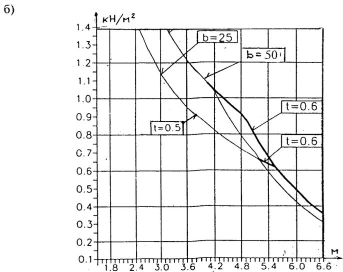
Рис.3. Зависимость “пролет-нагрузка” для однопролетной панели 50 С 50 (а) и 50 С 80 (б);
