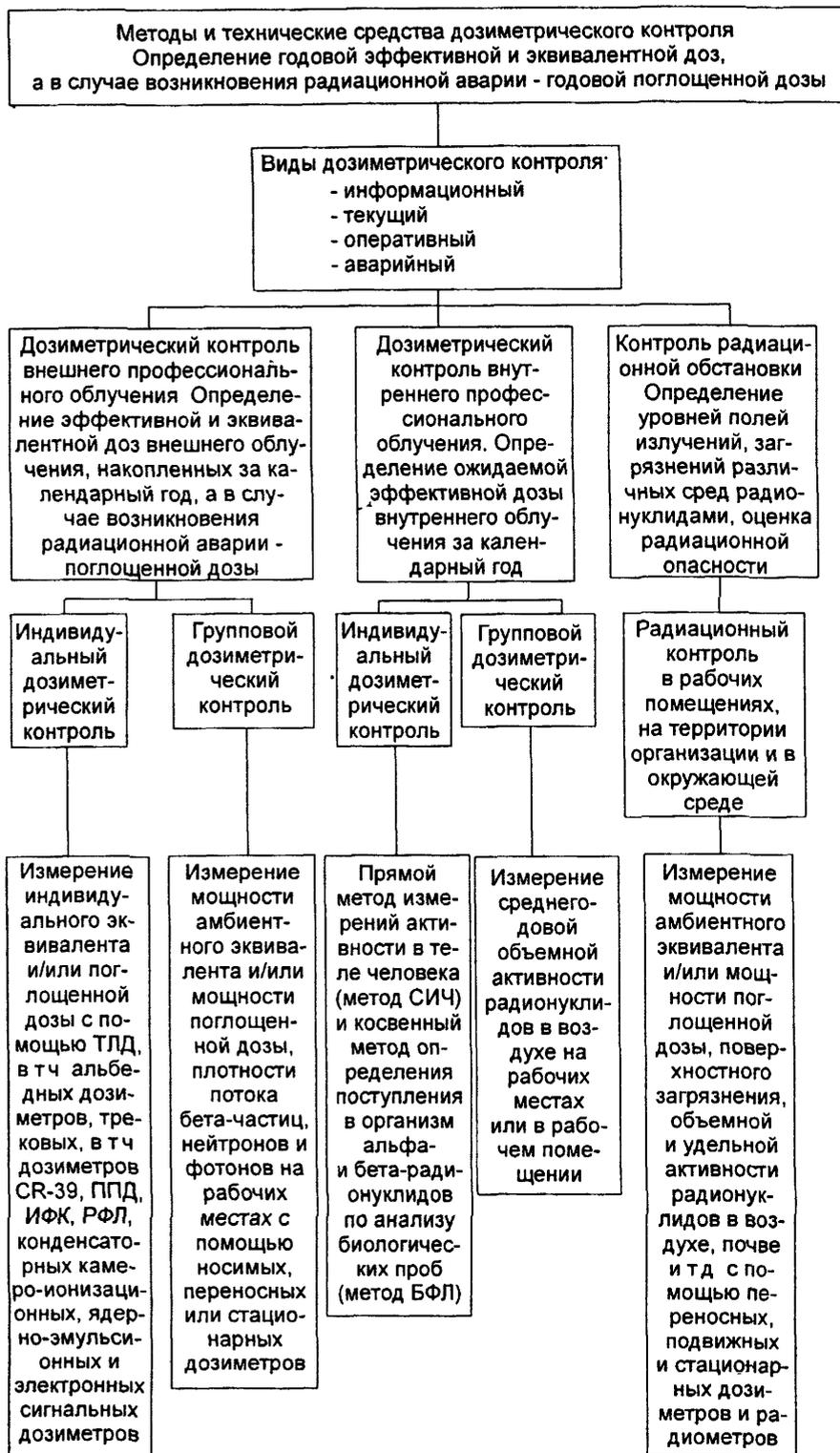
Рисунок 2. Методы и технические средства дозиметрического контроля
