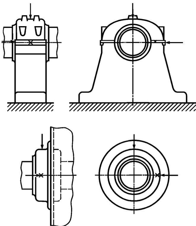
Рисунок 1 — Точки измерений на коренных подшипниках
