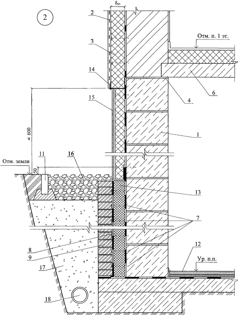
Вариант с поверхностным сбросом дождевой воды и защитной гидроизоляции пленкой "Тефонд"
