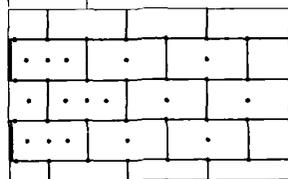
1. Количество дюбелей, устанавливаемых на  $1 \text{ м}^2$  системы, зависит от размеров плиты утеплителя и допустимой нагрузки на дюбель + высоты ( $h$ ).
