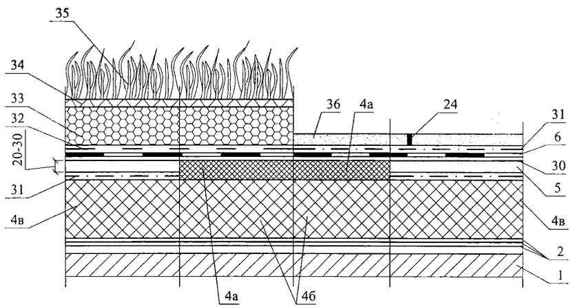
9 Пропуск трубы через традиционную эксплуатируемую кровлю
