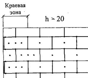
1. Количество дюбелей, устанавливаемых на  $1 \text{ м}^2$  системы, зависит от размеров плиты утеплителя и допустимой нагрузки на дюбель + высоты ( $h$ ).
