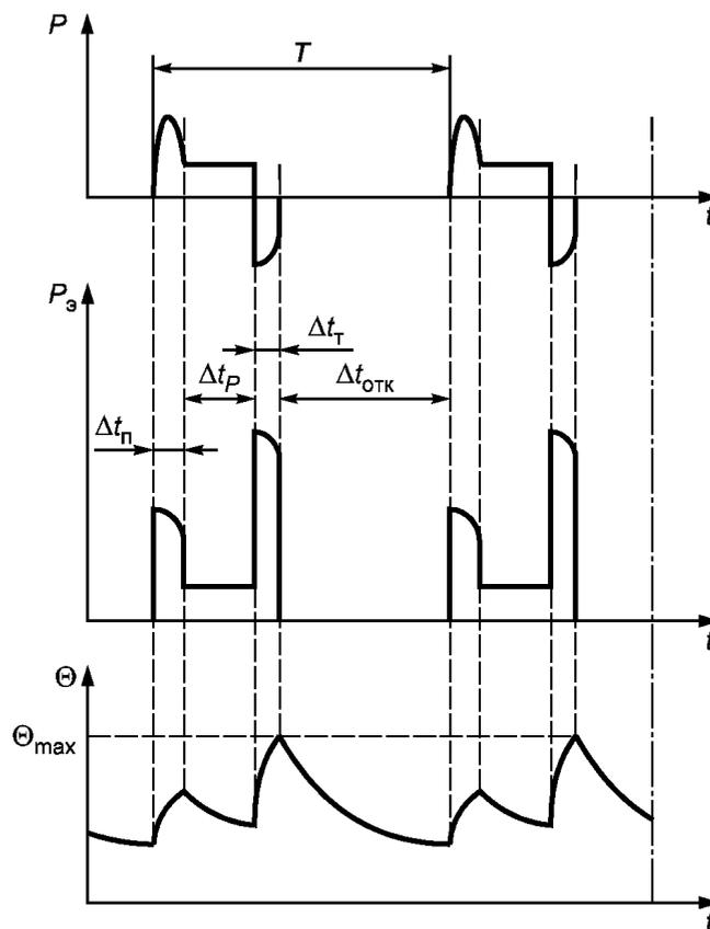
$P$  — нагрузка;  $P_э$  — электрические потери;  $\Theta$  — температура;  $\Theta_{\max}$  — достигнутая максимальная температура;  $t$  — время;  $\Delta t_p$  — время работы с постоянной нагрузкой;  $T$  — время одного цикла нагрузки;  $\Delta t_{отк}$  — время остановки или отключения питания машины;  $\Delta t_n$  — время пуска (разгона);  $\Delta t_t$  — время электрического торможения
