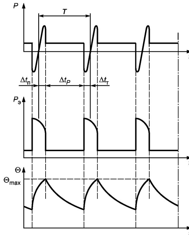
$P$  — нагрузка;  $P_э$  — электрические потери;  $\Theta$  — температура;  $\Theta_{max}$  — достигнутая максимальная температура;  $t$  — время;  $\Delta t_p$  — время работы с постоянной нагрузкой;  $T$  — время одного цикла нагрузки;  $\Delta t_n$  — время пуска (разгона);  $\Delta t_t$  — время электрического торможения
