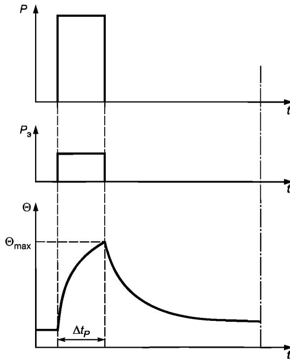
$P$  — нагрузка;  $P_э$  — электрические потери;  $\Theta$  — температура;  $\Theta_{max}$  — достигнутая максимальная температура;  $t$  — время;  $\Delta t_p$  — время работы с постоянной нагрузкой
