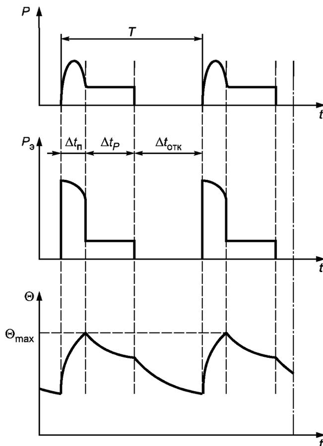
$P$  — нагрузка;  $P_э$  — электрические потери;  $\Theta$  — температура;  $\Theta_{max}$  — достигнутая максимальная температура;  $t$  — время;  $\Delta t_р$  — время работы с постоянной нагрузкой;  $T$  — время одного цикла нагрузки;  $\Delta t_{отк}$  — время остановки или отключения питания машины;  $\Delta t_п$  — время пуска (разгона)
