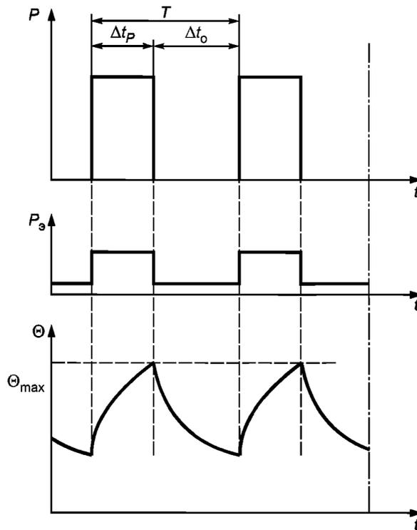
$P$  — нагрузка;  $P_s$  — электрические потери;  $\Theta$  — температура;  $\Theta_{\max}$  — достигнутая максимальная температура;  $t$  — время;  $\Delta t_p$  — время работы с постоянной нагрузкой;  $T$  — время одного цикла нагрузки;  $\Delta t_0$  — время работы без нагрузки
