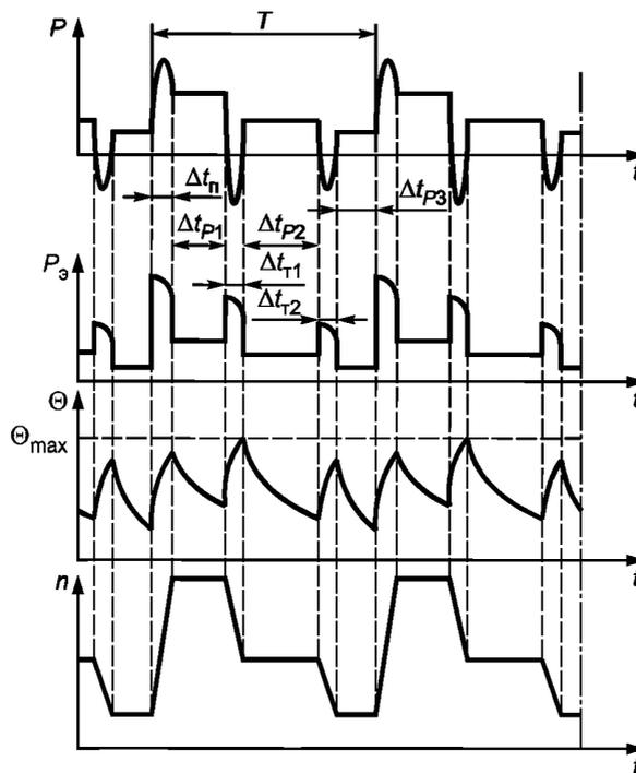
$P$  — нагрузка;  $P_3$  — электрические потери;  $\Theta$  — температура;  $\Theta_{\max}$  — достигнутая максимальная температура;  $t$  — время;  $\Delta t_P$  — время работы с постоянной нагрузкой ( $P_1$ ,  $P_2$ ,  $P_3$ );  $T$  — время одного цикла нагрузки ( $T_1$ ,  $T_2$ );  $\Delta t_n$  — время пуска (разгона);  $\Delta t_{r1, 2, \dots, i}$  — время электрического торможения;  $n$  — частота вращения
