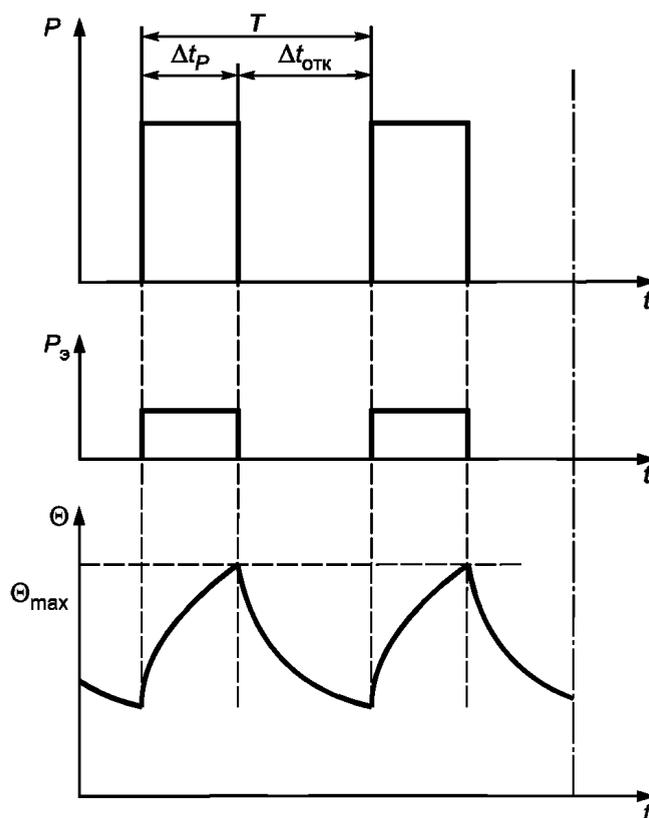
$P$  — нагрузка;  $P_э$  — электрические потери;  $\Theta$  — температура;  $\Theta_{\max}$  — достигнутая максимальная температура;  $t$  — время;  $\Delta t_p$  — время работы с постоянной нагрузкой;  $T$  — время одного цикла нагрузки;  $\Delta t_{\text{отк}}$  — время остановки или отключения питания машины
