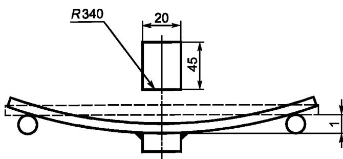
Рисунок 5 — Зажимное устройство для изгиба плавких вставок для поверхностного монтажа
