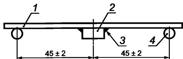
1 — стандартная разводка печатной платы; 2 — испытуемый образец; 3 — припой; 4 — опора
