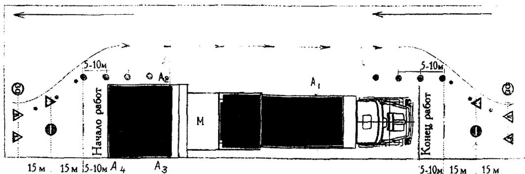
Рис. 1 Схема расположения машин и рабочих
