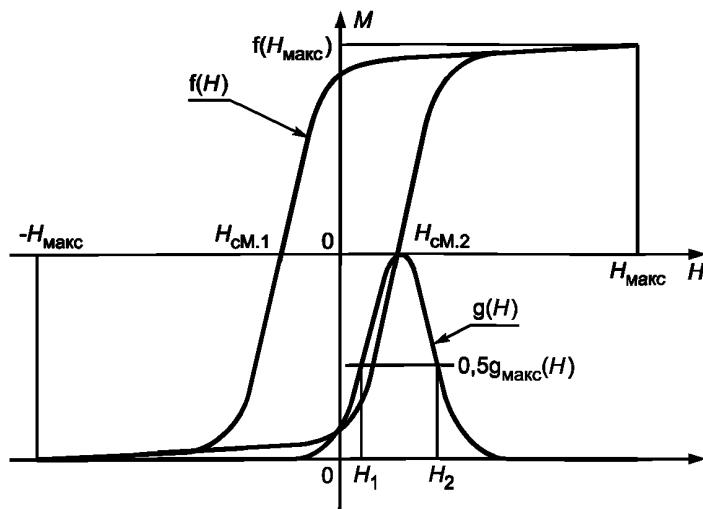
Рисунок 9 — Пример петли гистерезиса и ее дифференцированной кривой
