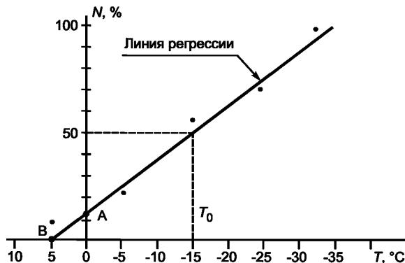
П р и м е ч а н и е — Из рисунка следует, что  $A = (0; 12)$  и  $B = (5; 0)$ , уравнение регрессии  $y = -2,5x + 12$  и для 50 % повреждения  $T_0 \approx -15^{\circ}\text{C}$ .
