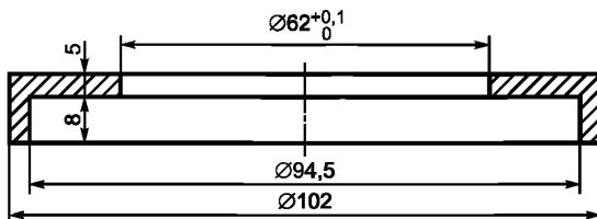
Д – кольцеобразная деталь для центрирования на приборе (низкоуглеродистая сталь)
