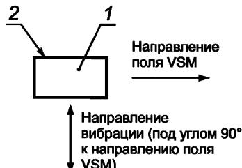
1 — образец; 2 — кромка образца
