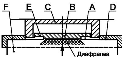
Е – образец материала (площадь 11,08 см<sup>2</sup>); F – опорная плита прибора
