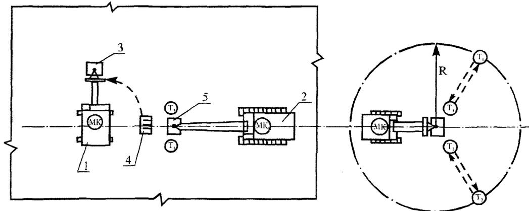
R - радиус опасной зоны, равный высоте поднятой трамбовки + 5 м
