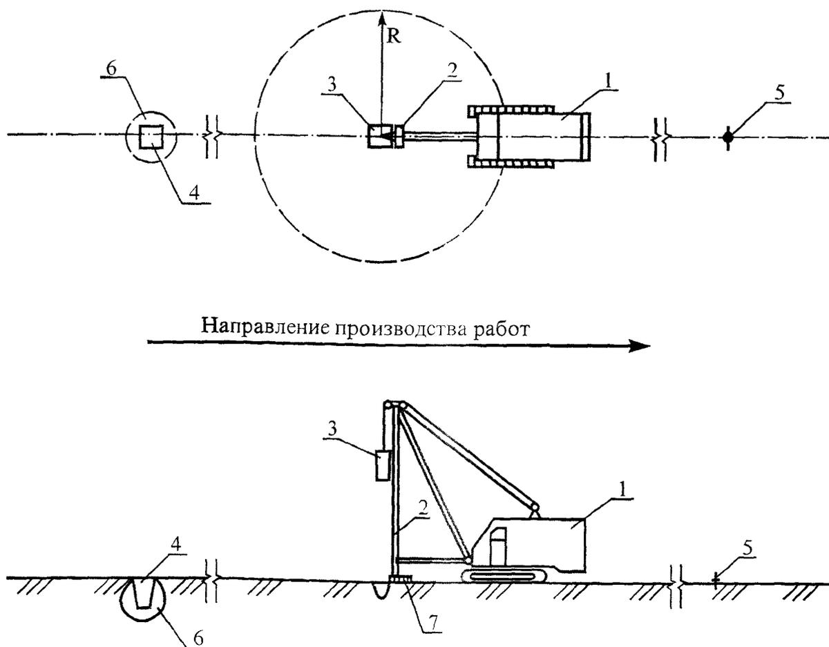
1 – кран-экскаватор; 2 – направляющая штанга; 3 – трамбовка; 4 – вытрамбованный котлован; 5 – разметка будущего котлована; 6 – уплотненная зона; 7 – опорная прокладка
