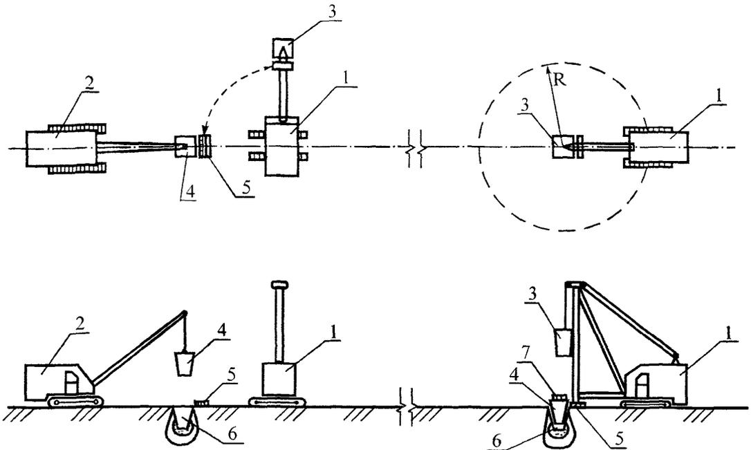
1 – кран-экскаватор; 2 – гусеничный кран; 3 – трамбовка; 4 – фундаментный блок; 5 – опорная прокладка; 6 – котлован; 7 – деревянная прокладка для предохранения фундаментного блока от разрушения при ударе трамбовкой
