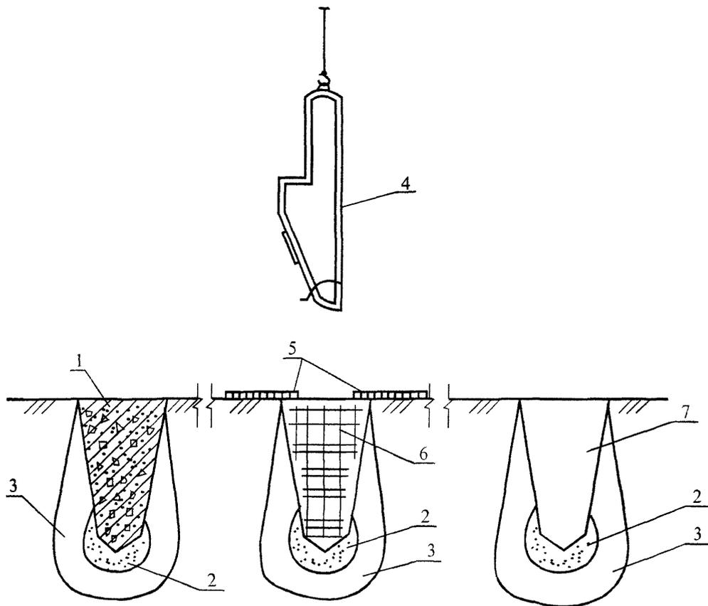
1 – забетонированный фундамент; 2 – уширенное основание; 3 – уплотненная зона; 4 – бункер для подачи бетона; 5 – настил (по проекту); 6 – арматурный каркас; 7 – вытрамбованный котлован.
