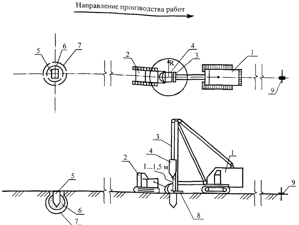
1 – кран-экскаватор Э-10011; 2 – тракторный погрузчик ТО-7А; 3 – направляющая штанга; 4 – трамбовка; 5 – вытрамбованный котлован; 6 – втрамбованный в дно котлована жесткий материал; 7 – уплотненная зона; 8 – опорная прокладка; 9 – разметка будущего котлована.
