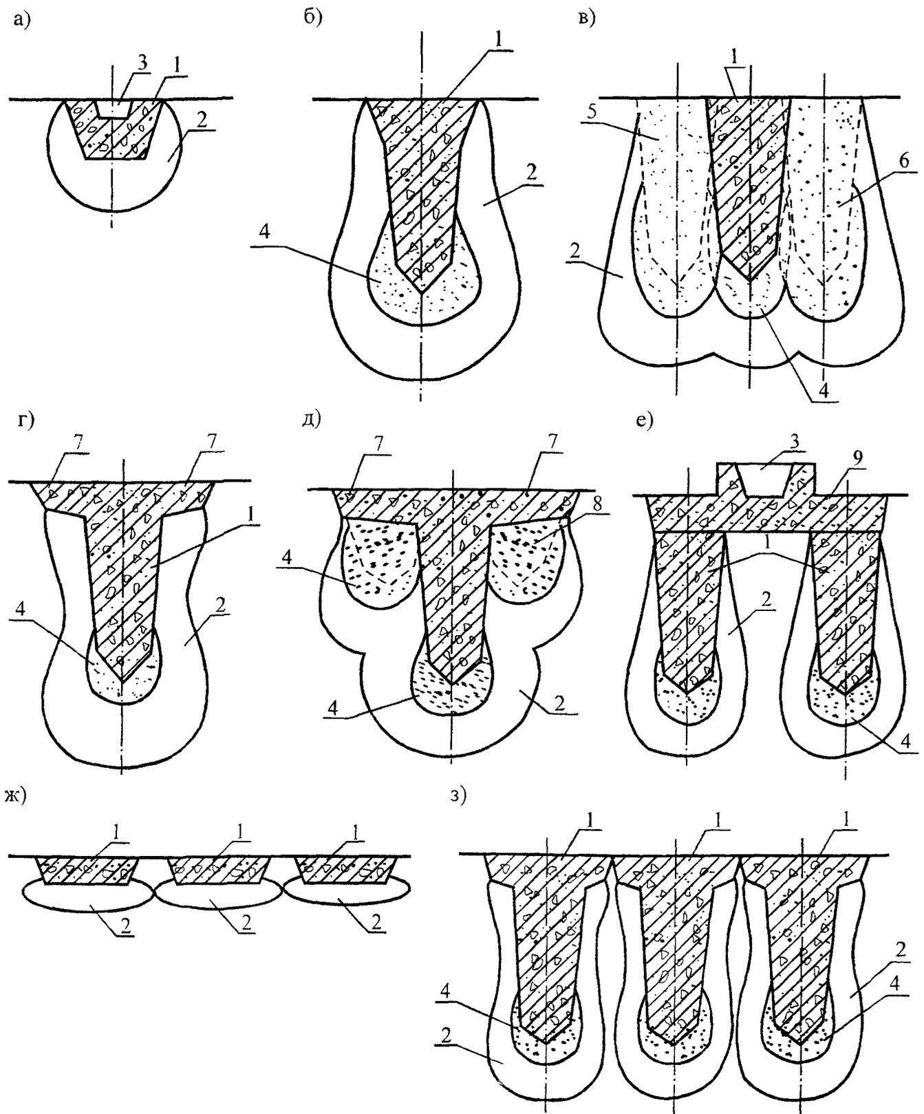
1 – фундамент; 2 – уплотненная зона; 3 – стакан для установки колонны; 4 – втрамбованный жесткий грунтовой материал; 5 – 6 – дополнительные котлованы для создания несущего слоя; 7 – консоли; 8 – дополнительные котлованы под консоли; 9 – ростверк.
