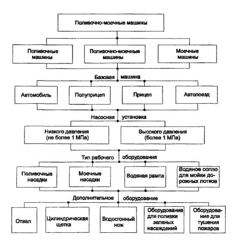
распространенные универсальные поливочно-моечные. Поливочно-моечные машины базируются на автомобильных шасси, а также на грузовых полуприцепах и прицепах. По типу насосной установки поливочно-моечные машины можно разделить на машины с низким (до 1,0 МПа) и с высоким давлением воды (более 1,0 МПа). Повышенное давление воды при мойке дорожных покрытий позволяет уменьшить расход воды на единицу площади
