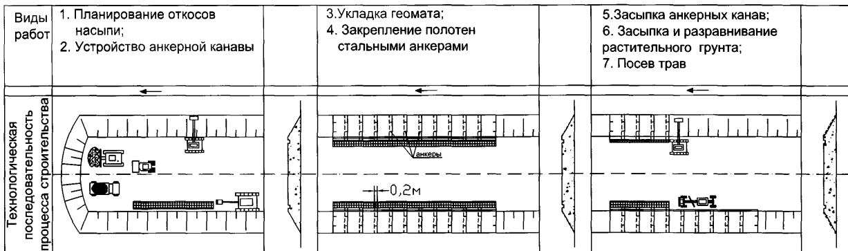
Технологическая схема укрепления откосов геоматами
