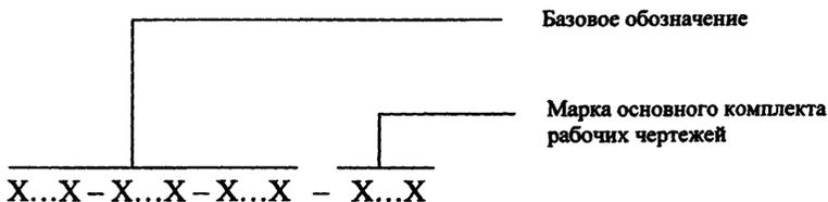
Пример обозначения основного комплекта рабочих чертежей здания:
