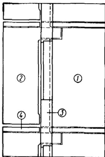
Рис. 8. Схема навески стены выдвинутой лоджии
