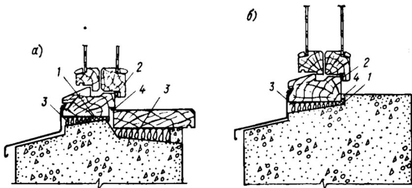
**Рис. 6.** Варианты примыкания оконной коробки к нижней грани проема
