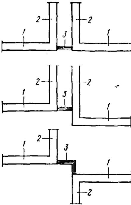
1 — наружная продольная стена отсека; 2 — утепленная торцовая стена отсека; 3 — вертикальная декоративная вставка между стенами отсека, легко разрушаемая при деформациях основания
