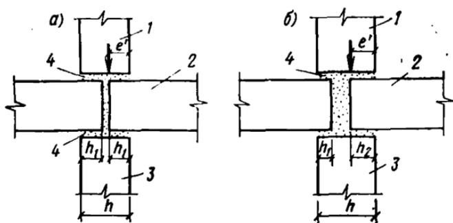
Рис. 26. Платформенные стыки с двухсторонним опиранием перекрытий
