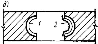
Рис. 19. Схемы шпоночных соединений
