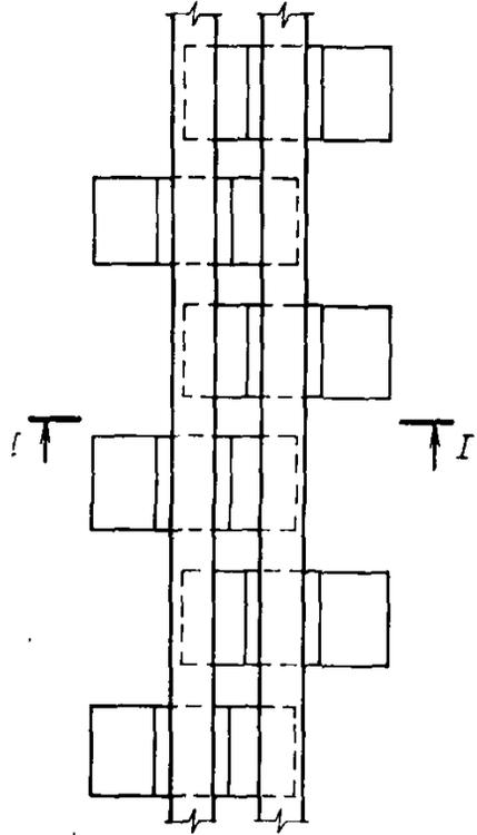
Рис. 13. Схема вертикальных деформаций продольной стены от искривления основания
