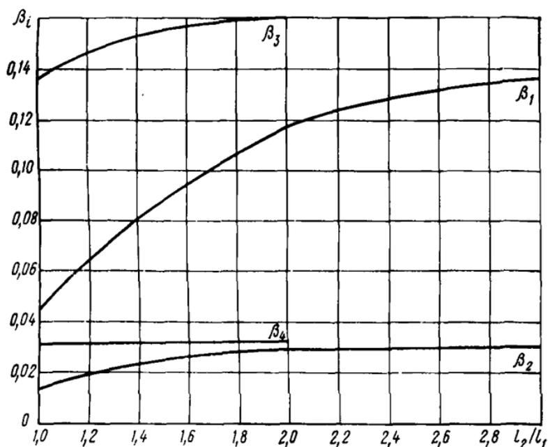
Рис. 32. Графики для определения коэффициентов  $\beta_1$ — $\beta_4$ .
