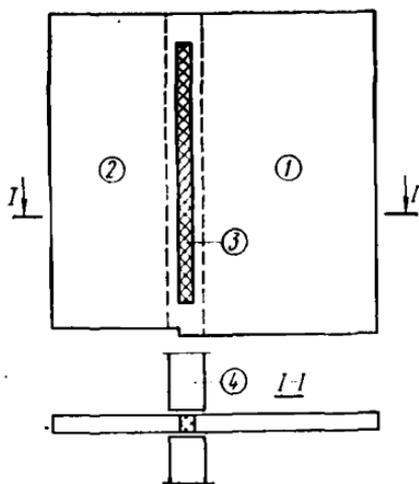
Рис. 7. Схема стены выдвинутой лоджии, изготовляемой совместно с панелью внутренней стены
