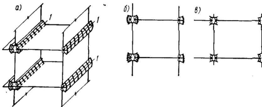
Рис. 17. Расчетные схемы при расчете на изгиб из плоскости
