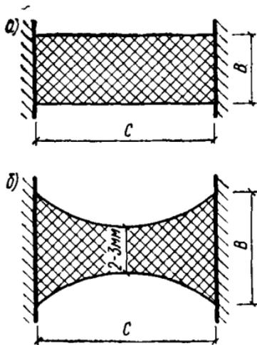
Рис. 5. Форма и размеры уплотнителя
