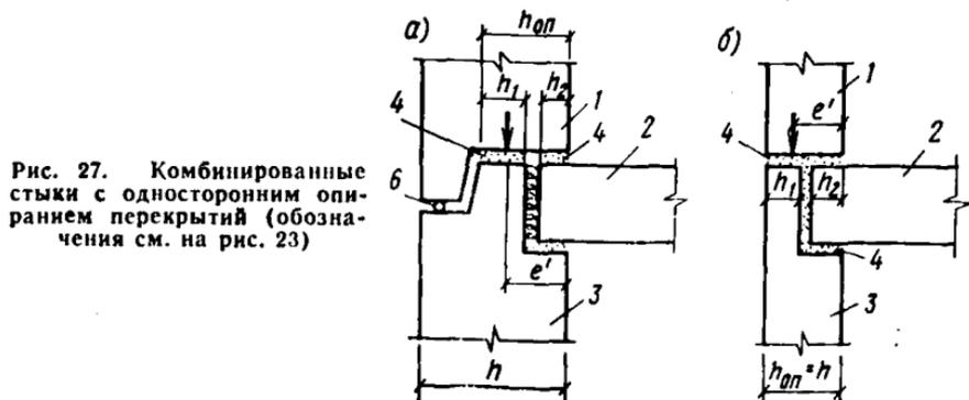
Рис. 27. Комбинированные стыки с односторонним опиранием перекрытий (обозначения см. на рис. 23)
