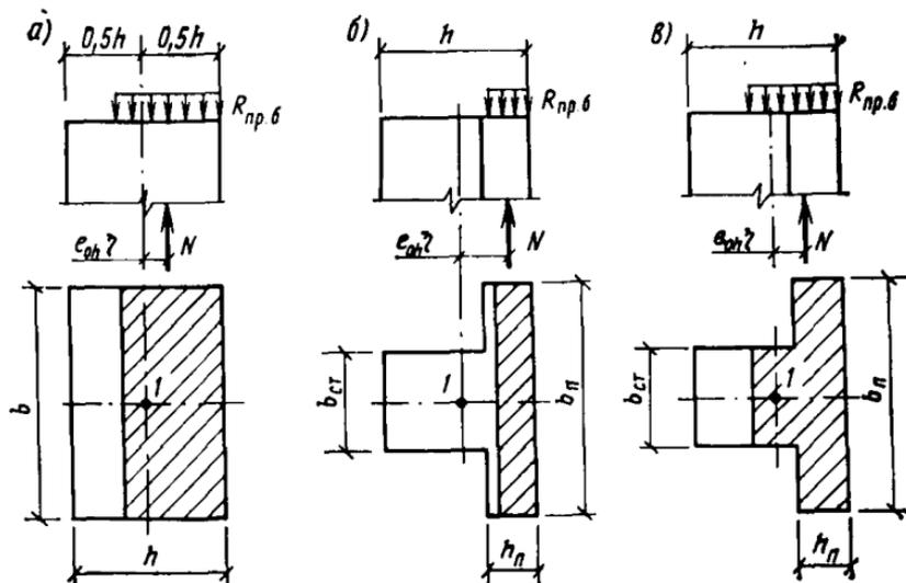
Рис. 33. Схемы к расчету прочности горизонтальных сечений бетонных панелей
