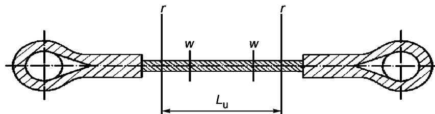
$L_u$  — эффективная длина, измеренная без нагрузки;  $r$  — ограничительные метки для стандартного испытания;
