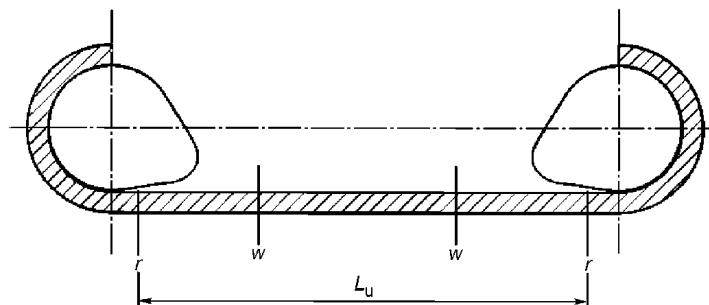
$L_u$  — эффективная длина, измеренная без нагрузки;  $r$  — ограничительные отметки для стандартного испытания;
