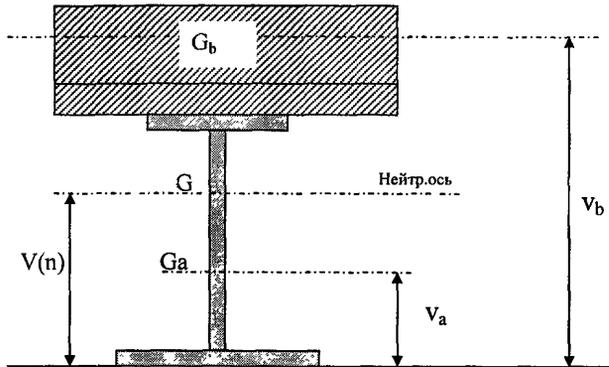
Рисунок 20 – Положение нейтральной оси в балке
