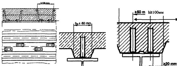
Рисунок 26 – Расположение упоров параллельно оси балки
