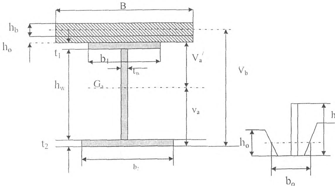
Рисунок 18 – К расчету комбинированной балки
