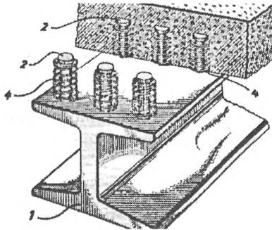
1 – стальная балка перекрытия; 2 – стэд-болт; 3 – бетон; 4 – стальная пружина
