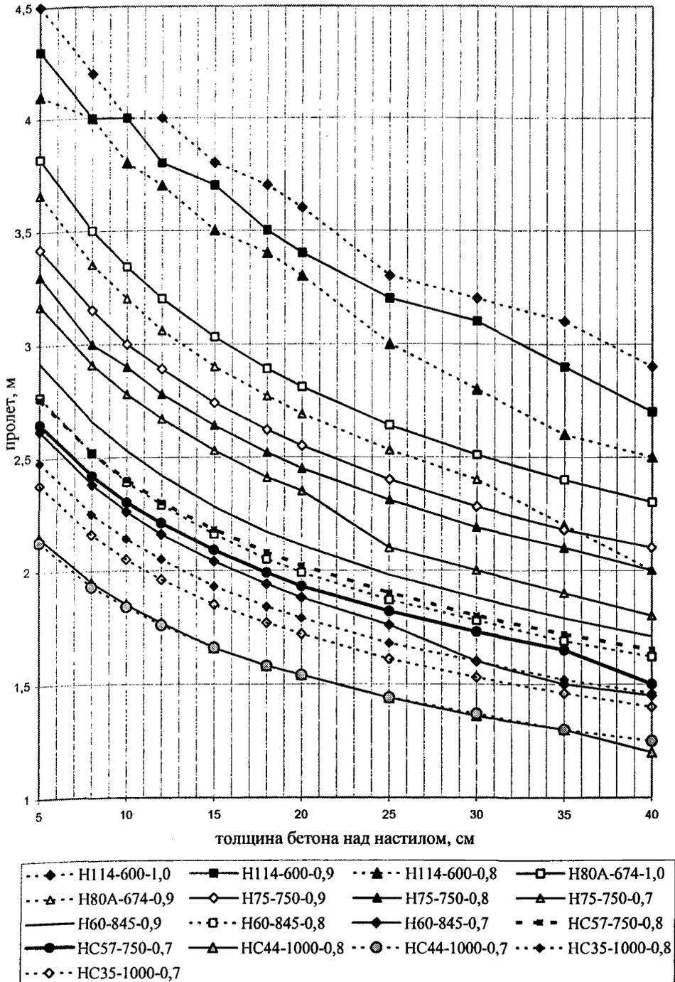
Рисунок 2 – Зависимость максимального пролета настила от толщины свежеуложенного бетона над настилом при его однопролетной схеме
