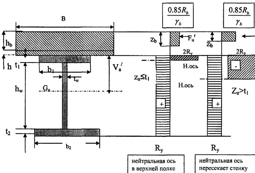
Рисунок 19 – Положение нейтральной оси в балке
