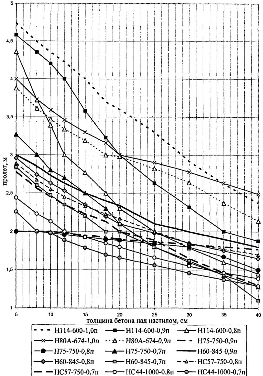
Рисунок 5 – Зависимость максимального пролета настила от толщины свежесуложенного бетона над настилом при его неразрезной двухпролетной схеме
