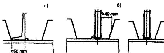
Рисунок 25 – Расположение упоров вдоль (а) и поперек (б) оси балки
