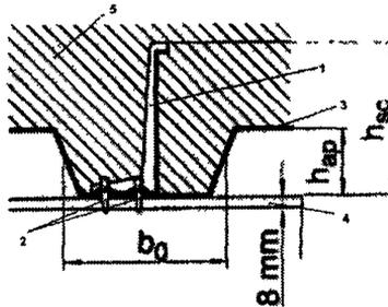
1 - анкер X-HVB; 2 – дюбель; 3 – настил; 4 – базовая конструкция; 5 – бетон плиты.
