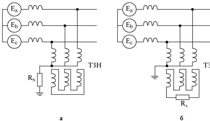
Рисунок 1 – Схемы подключения резистора к нейтрали сети
