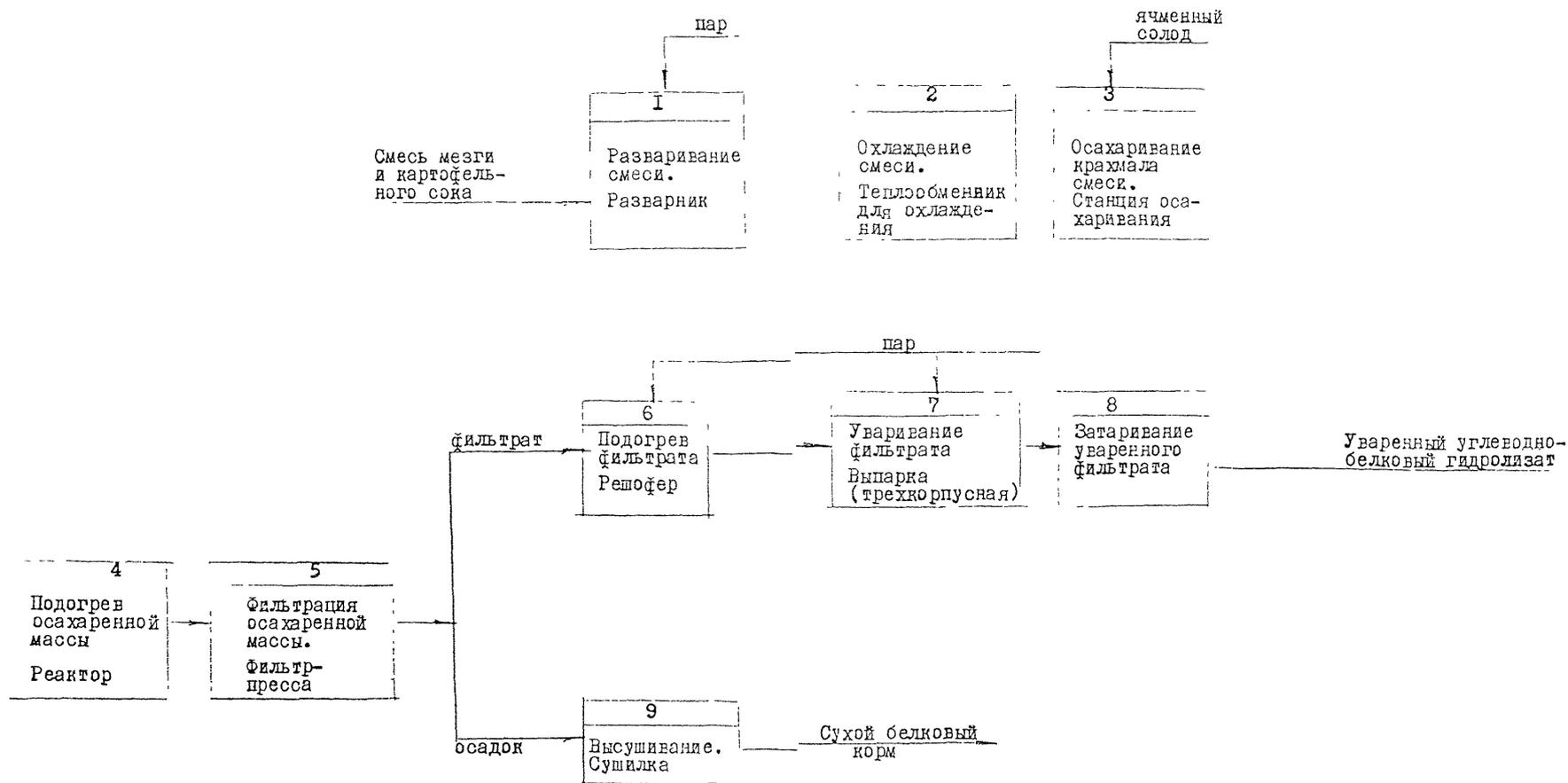
Принципиальная технологическая схема производства
