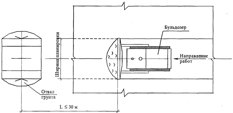
Рисунок 1 – Схема производства работ по планировке поверхности земли бульдозером
