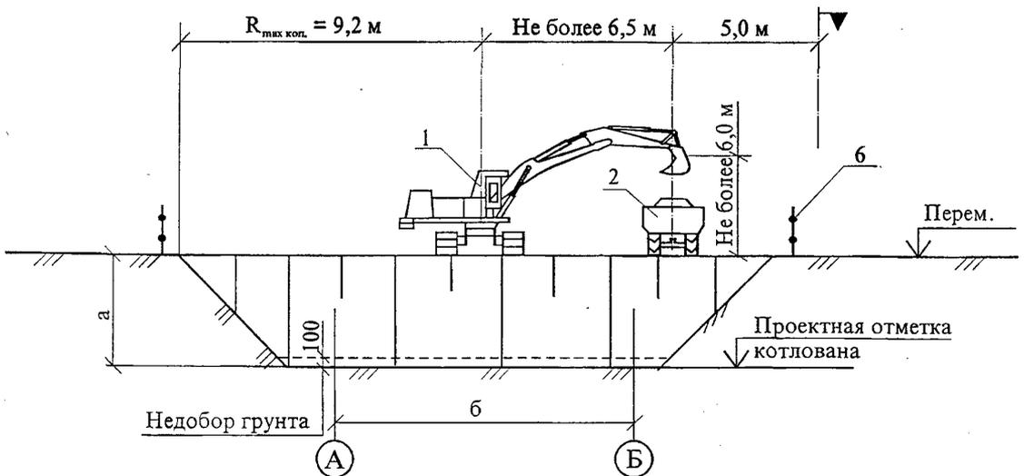
1 – экскаватор; 2 – автосамосвал; 3 – рабочий ход экскаватора; 4 – ось движения автосамосвала; 5 – геодезический знак закрепления осей; 6 – ограждение котлована; 7 – контур монолитной фундаментной плиты; 8 – лестница для спуска в котлован; 9 – граница опасной зоны
