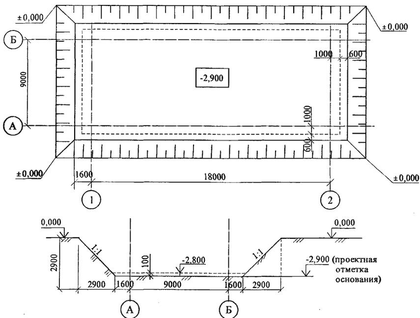
Рисунок 4 – Пример геометрии котлована для цифровых расчетов
