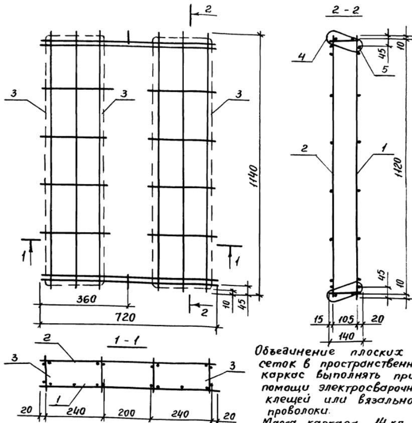
Объединение плоских сеток в пространственный каркас выполнять при помощи электросварочных клещей или вязальной проволоки.
