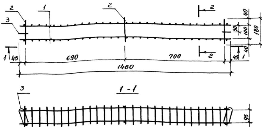
Объединение плоских каркасов в пространственный выполнять при помощи электросварочных клещей. Установку строповой петли ПМ2 (поз.3) см. узел I стр. 16
