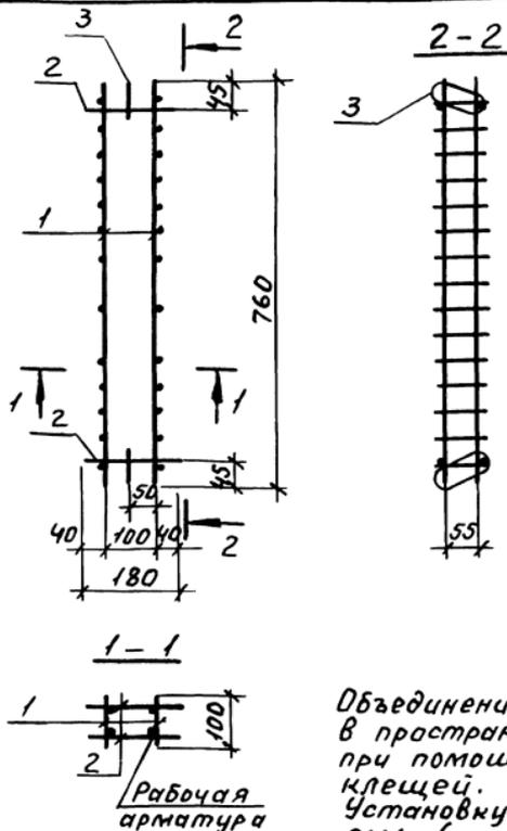
Объединение плоских каркасов в пространственный выполнять при помощи электросварочных клещей.
