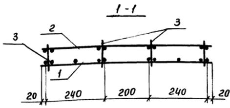
Объединение плоских сеток в пространственный каркас выполнять при помощи электросварочных клещей или вязальной проволоки.
