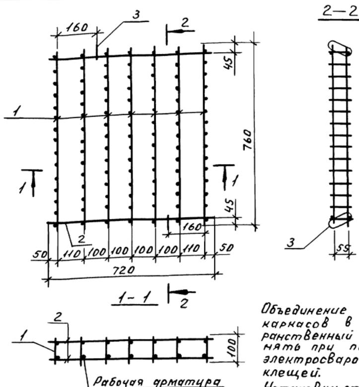
Объединение плоских каркасов в пространственный выполняют при помощи электросварочных клещей.
