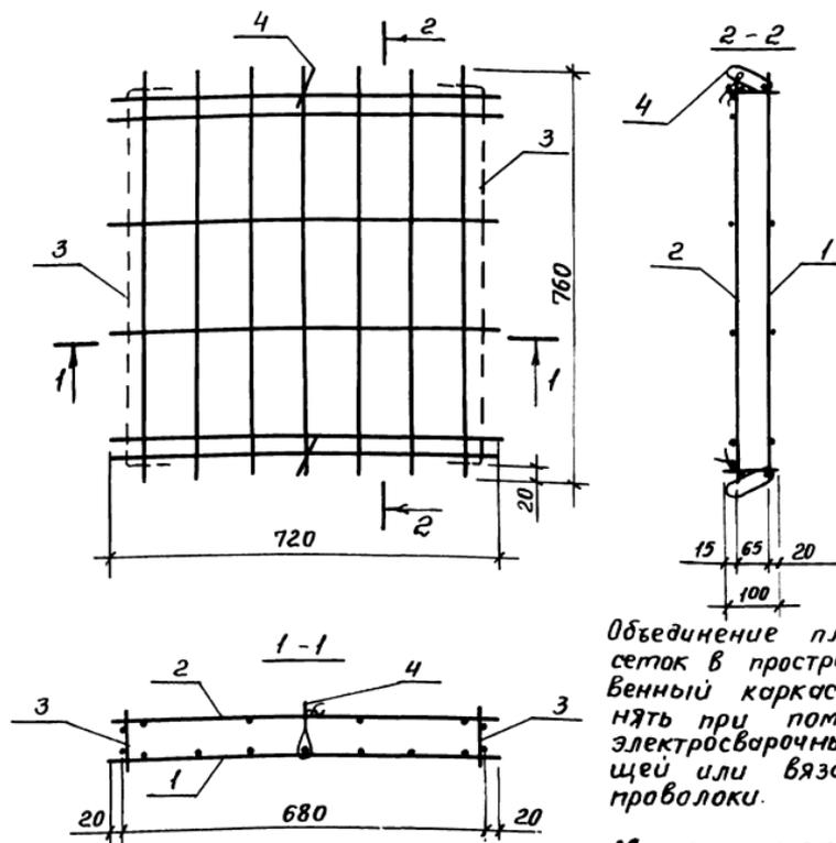
Объединение плоских сеток в пространственный каркас выполняется при помощи электросварочных клещей или вязальной проволоки.
