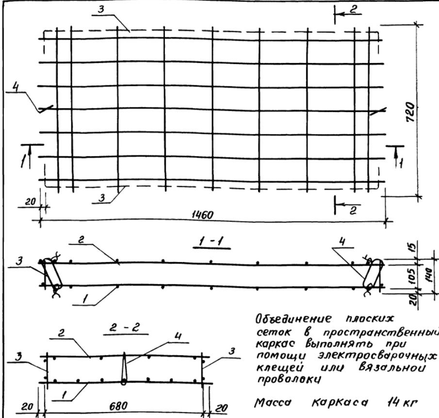
Объединение плоских сеток в пространственный каркас выполнять при помощи электросварочных клещей или вязальной проволоки
