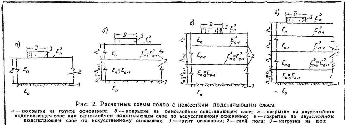
Модули деформации материала отдельных слоёв принимают по табл. 2, а грунта основания по табл. 3. Толщину отдельных слоёв пола принимают по Разделу I. Толщину прослоек и мастик, а также гидроизоляционных слоёв от сточных вод и других жидкостей включают в толщину покрытия. Толщину прослоек, расположенных на подстилающем слое, не учитывают.
