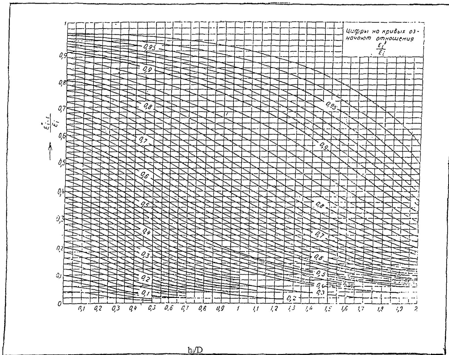
Рис. 3 График для расчёта пола с жестким подстилающим слоем
