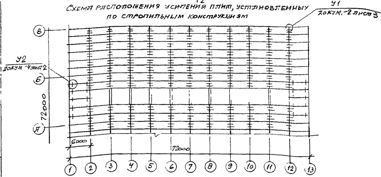
СХЕМА РАСПОЛОЖЕНИЯ УСИЛЕНИЯ ПЛИТ, УСТАНОВЛЕННЫХ ПО ФОНАРЯМ
